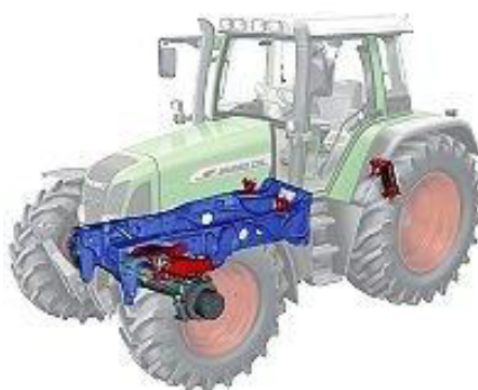
Obr. 2: Podvozek polorámové konstrukce Fendt-Favorit 700 Vario [6]
