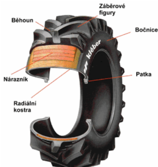
Obr. 10: Řez pláštěm radiální traktorové pneumatiky [5]
