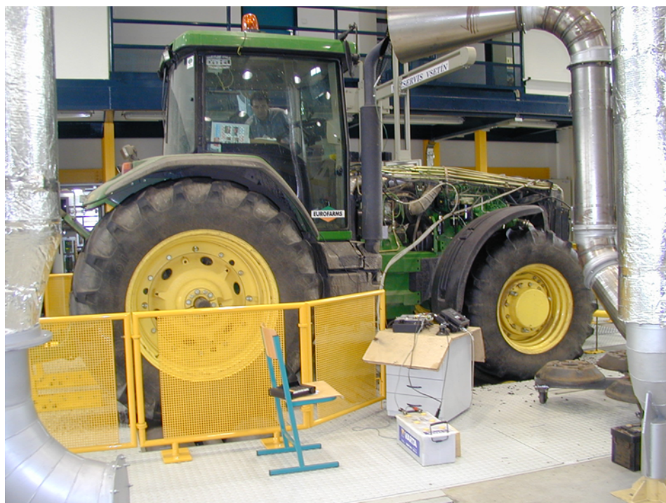
Obr. 25: Válcový dynamometr pro měření tahových charakteristik traktorů.
