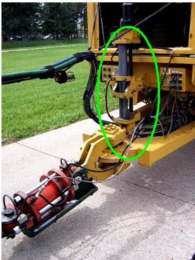
Obr. 23: Nastavení výšky bodu závěsu na měřícím vozidle [12]
