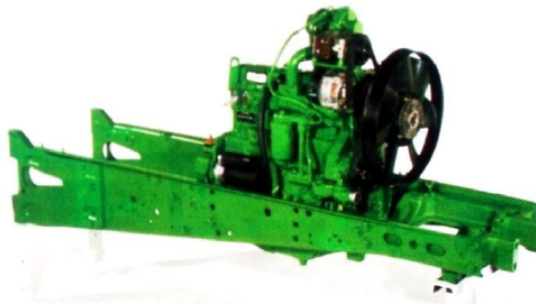
Obr. 4: Rámová konstrukce John Deere 5820 [12]
