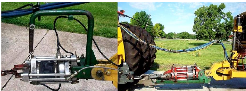
Obr. 19: Snímače tahové síly [12]
