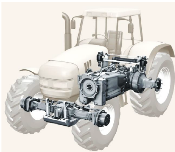
Obr. 1: Podvozek traktoru bezrámové samonosné konstrukce [12]
