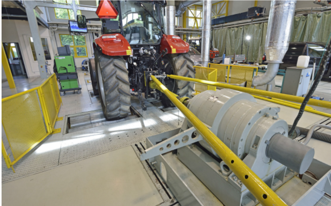
Obr. 21: Válcová zkušebna pro měření tahových vlastností traktorů Tess Vsetín s.r.o. [19]
