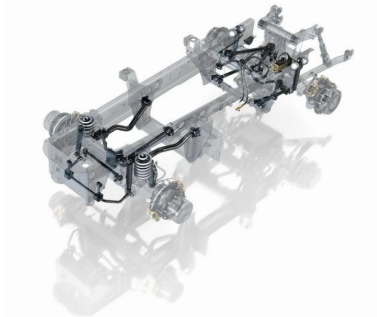
Obr. 3: Rámová konstrukce traktoru JCB Fastrac [7]
