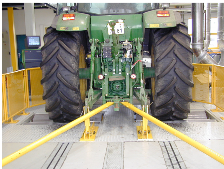
Obr. 26: Válcový dynamometr pro měření tahových charakteristik traktorů.
