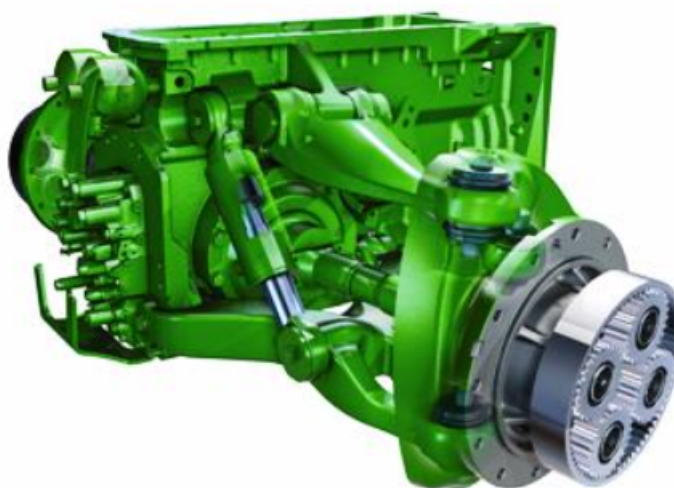
Obr. 6: Odpružená náprava John Deere ILS [1]
