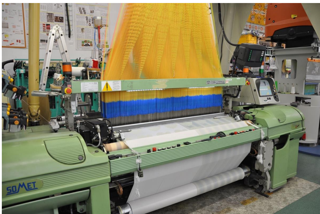
Obr. 42: Jehlový tkací stroj Somet s elektronickým žakárským prošlupným mechanizmem Staübli (Tkalcovna FT TUL)
