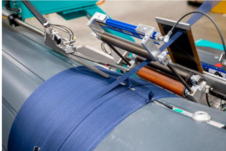
Obr. 2: Snovací stůl s automatickým systémem tažných tyčí a válečky s automatickým otevíráním a vyrovnávacím válečkem [7]
