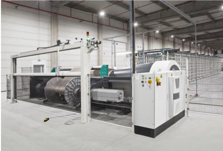
Obr. 4: Snovací stroj PROWARP vč. cívečnice [7]
