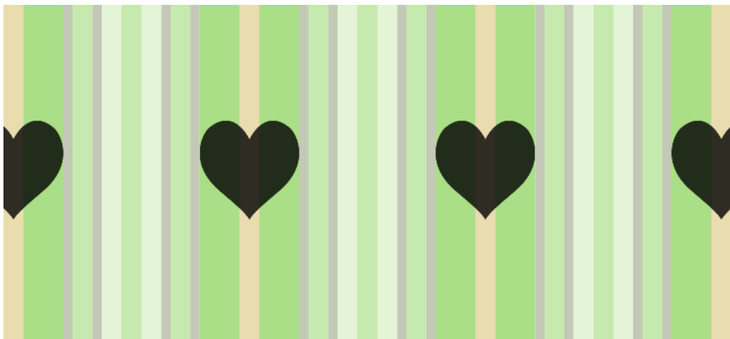
Obrázek 14: Náhled na snovanou osnovu se symetricky rozloženým motivem, kde osa symetrie snovaného vzoru je prostřední žlutý proužek
