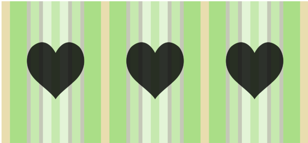
Obrázek 15: Náhled na snovanou osnovu se symetricky rozloženým motivem, kde osa symetrie snovaného vzoru je prostřední zelený proužek
