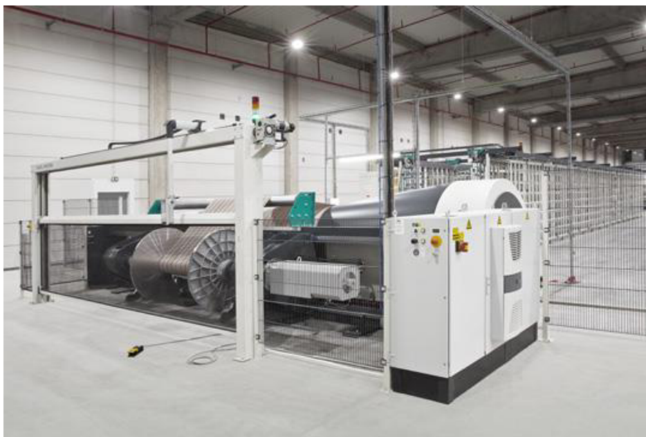
Obr. 4: Snovací stroj PROWARP vč. cívečnice [7]
