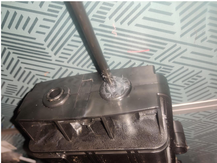
Obr. B.4: Fotografie ztmelení vyvrtaných děr v optickém boxu.
