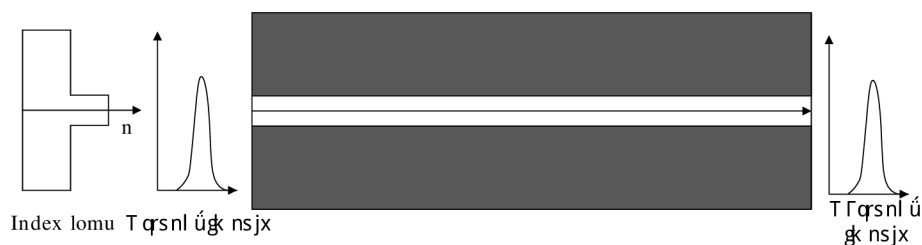
Obr. 2.1: Šíření paprsku jednovidovým vláknem se skokovým indexem lomu [6].
