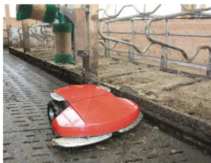
Obrázek 2.9: Robot ENRO na betonových roštích (Schauer-agrotronic.com, bez uvedení data)
