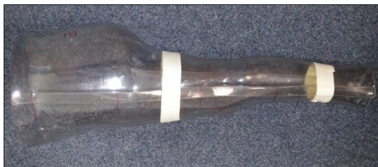
Obrázek 31 – Forma na nárazovou figurínu 62
