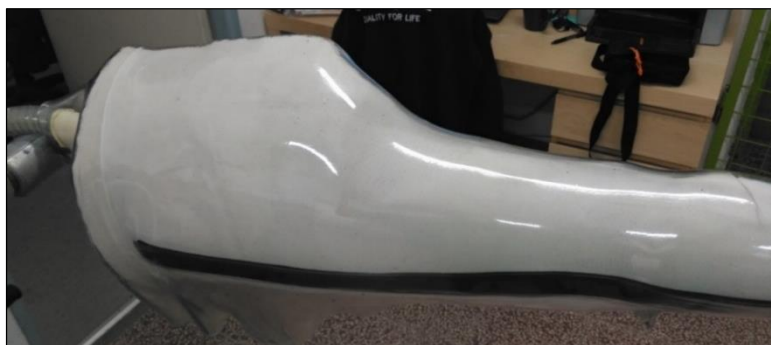
Obrázek 30 – Sádrový odlitek potažený plastem ThermoLyn Clear 61
