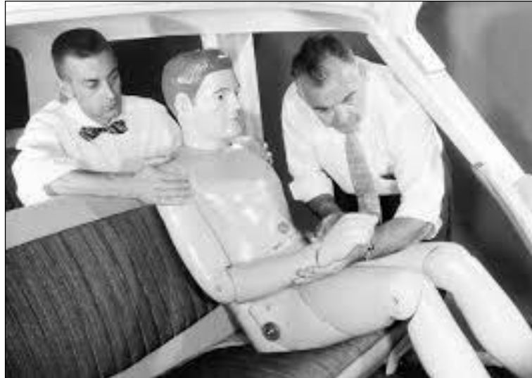
Obrázek 5 – Inženýři instalují figurínu do vozidla 13
