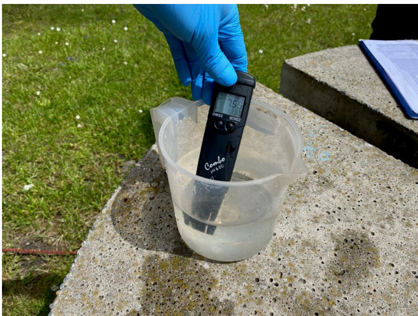
Obrázek 10: Měření vodivosti, pH a teploty vzorku vody v terénu
