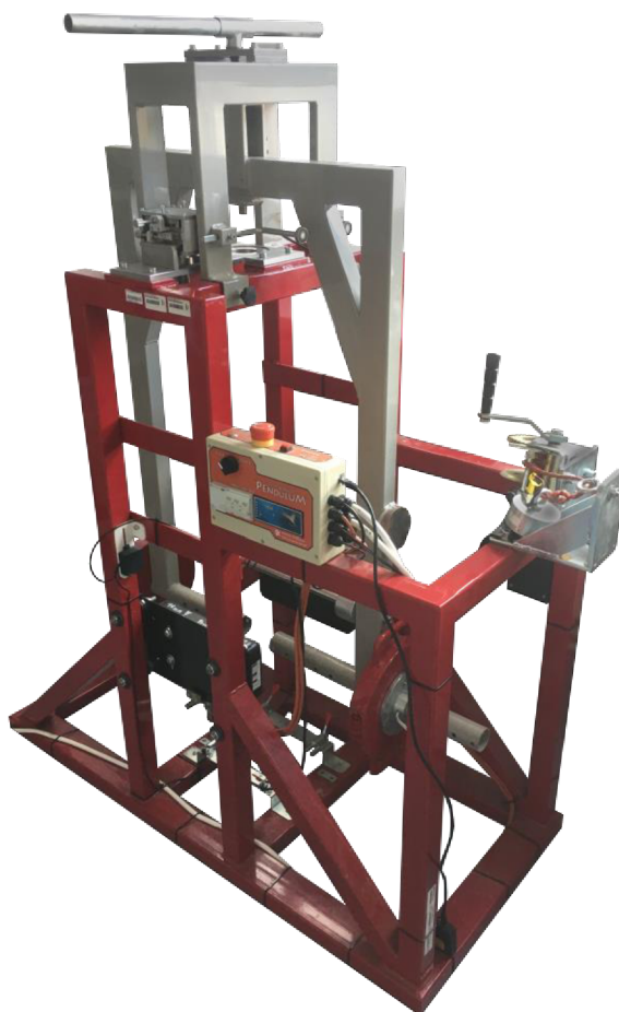
Obr. 4–4 Kyvadlový simulátor kyčelního kloubu
