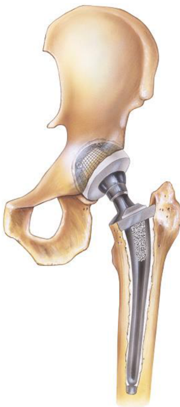
Obr. 1–1 Schéma TEP kyčle [44]
