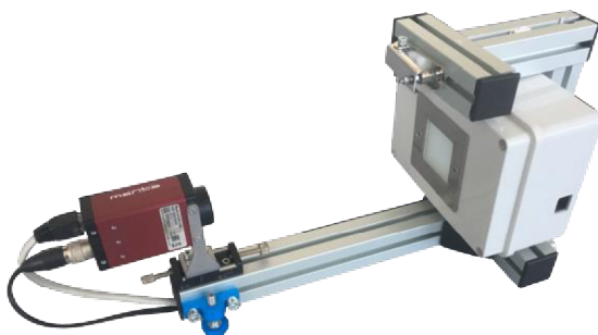
Obr. 4–2 Aparatura pro stanovení smáčivosti
