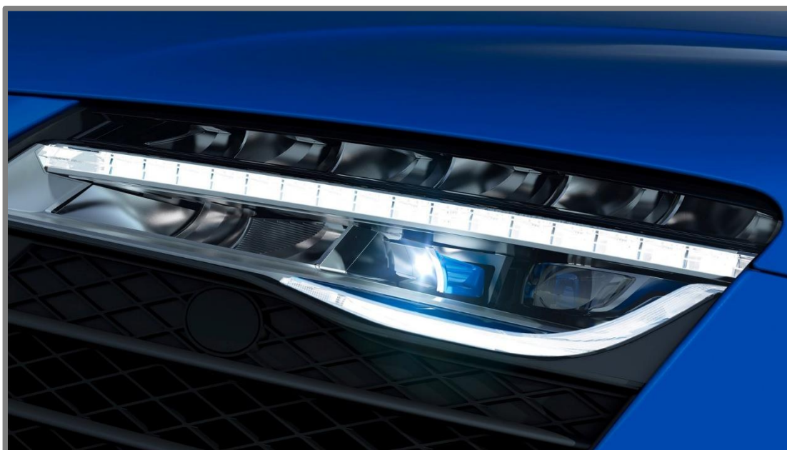
Obr. 2-4 Laserové svetlomety Audi R8 LMX [16]
