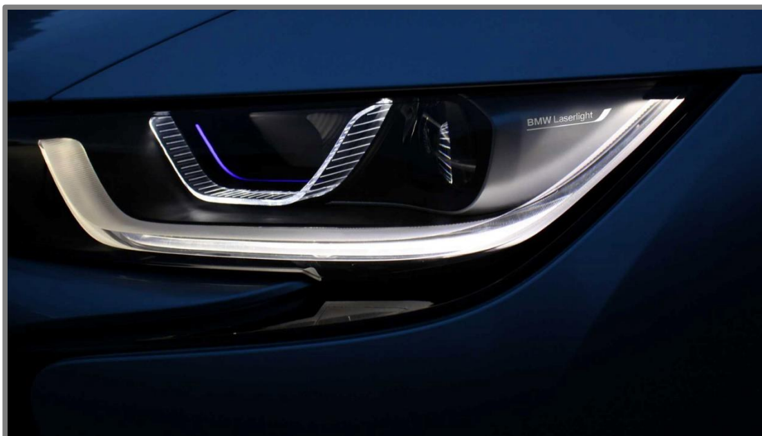
Obr. 2-3 Laserové svetlomety BMW i8 [17]
