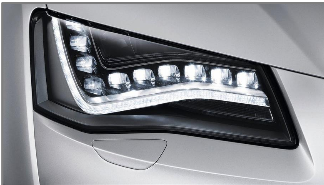
Obr. 2-2 Celo-LED svetlomet Audi S8 (športová verzia A8) s kontúrovými riešením stretávacieho svetla [16]
