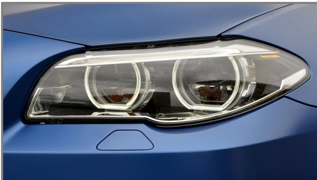
Obr. 2-11 Corona rings vytvorené pomocou svetlovodičov na BMW radu 5 [16]
