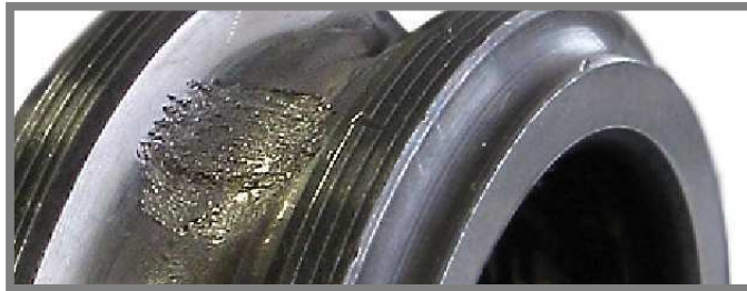
Obr. 3-3 Pitting na vnitřním kroužku ložiska
