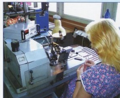
Navíjení rotorků na stroji MICALFIL Winding of rotors by the MICALFIL machine Rotoraufwickeln mittels MICALFIL - Maschine
