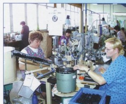
Poloautomat na montáž ostříkovačů Semiautomated machine for windscreen washers assembling Halbautomat für die Montage der Bespritzer
