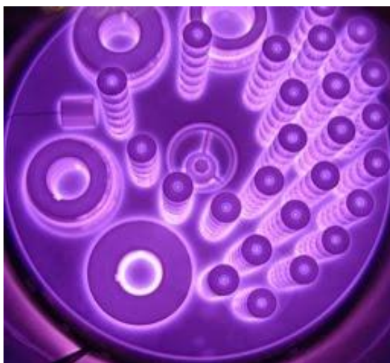
Obr. 8 Nitridace součástí v modro-fialovém anomálním výboji [20]
