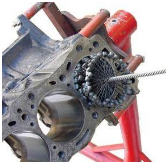
Obr. 7 Honování válců motoru metodou Flex Hone® [9]
