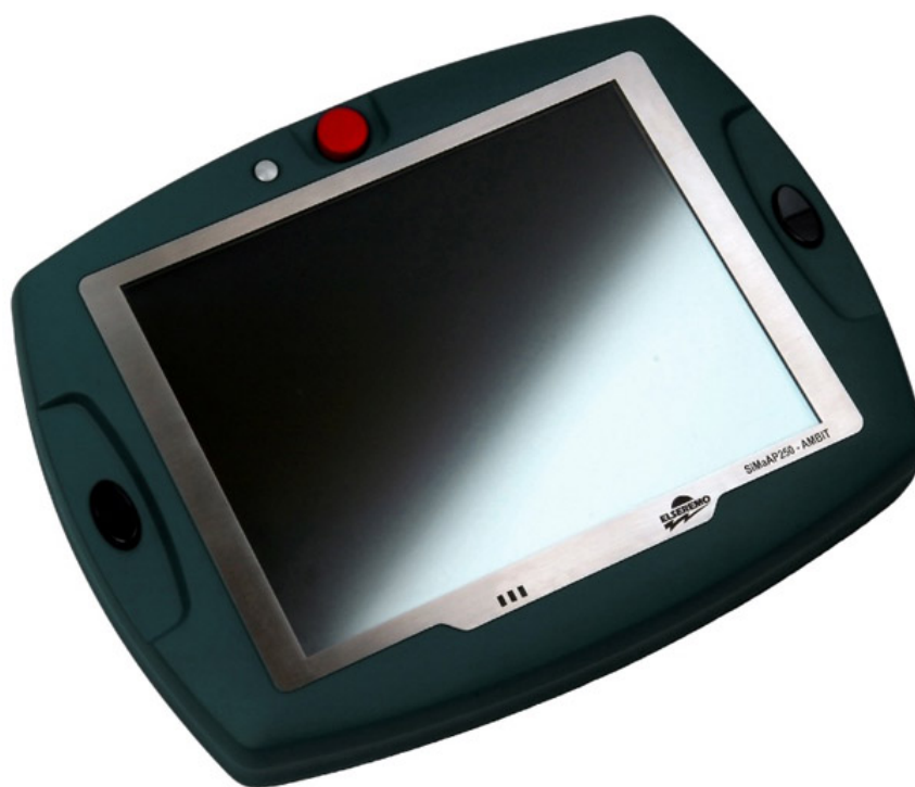
Obrázek 3.3 Mobilní ovládací pult AMBIT od firmy Elseremo
