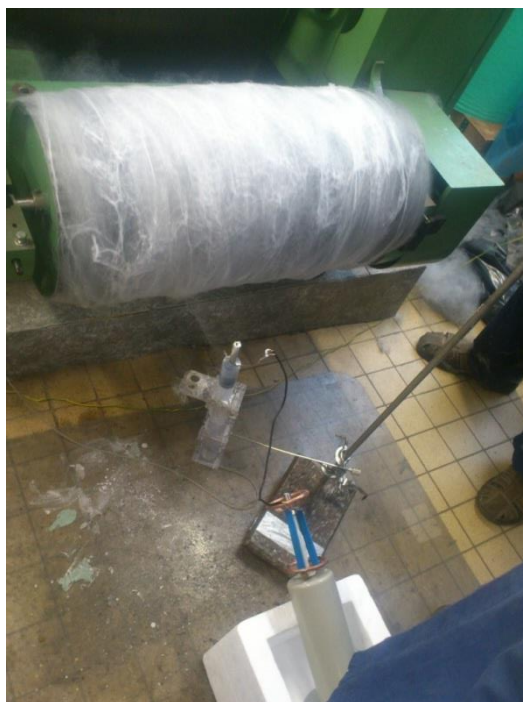
Obr. 10: Elektrostatické zvlákňování mykance
