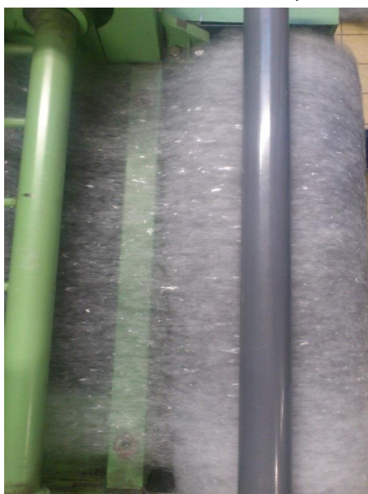
Obr. 11: Snímání mykance při použití 1% nanovláken
