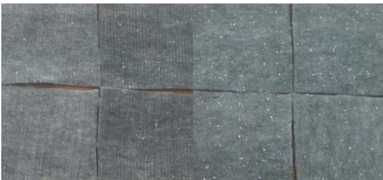
Obr. 22: netkaná textilie bez mřížky, s 1% nanovláken, vlevo (líc) a vpravo (rub)
