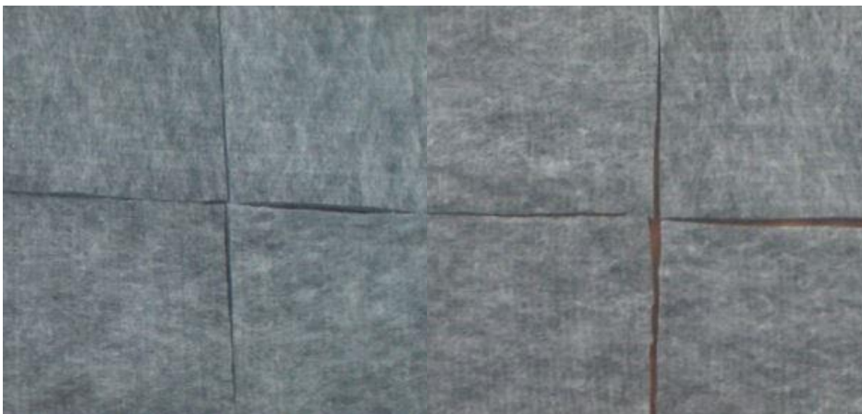
Obr. 19: netkaná textilie s mřížkou, s 0,3% nanovláken, vlevo (líc) a vpravo (rub)
