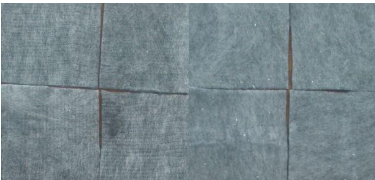
Obr. 20: netkaná textilie bez mřížky, s 0,3% nanovláken, vlevo (líc) a vpravo (rub)
