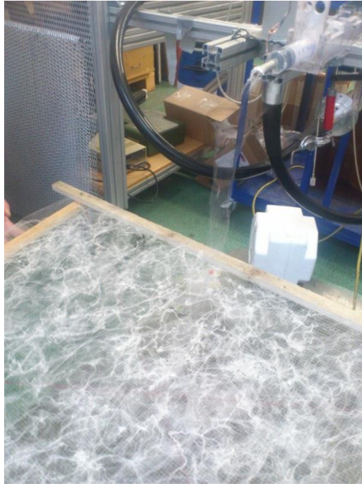
Obr. 12: Elektrostatické zvlákňování na mřížku
