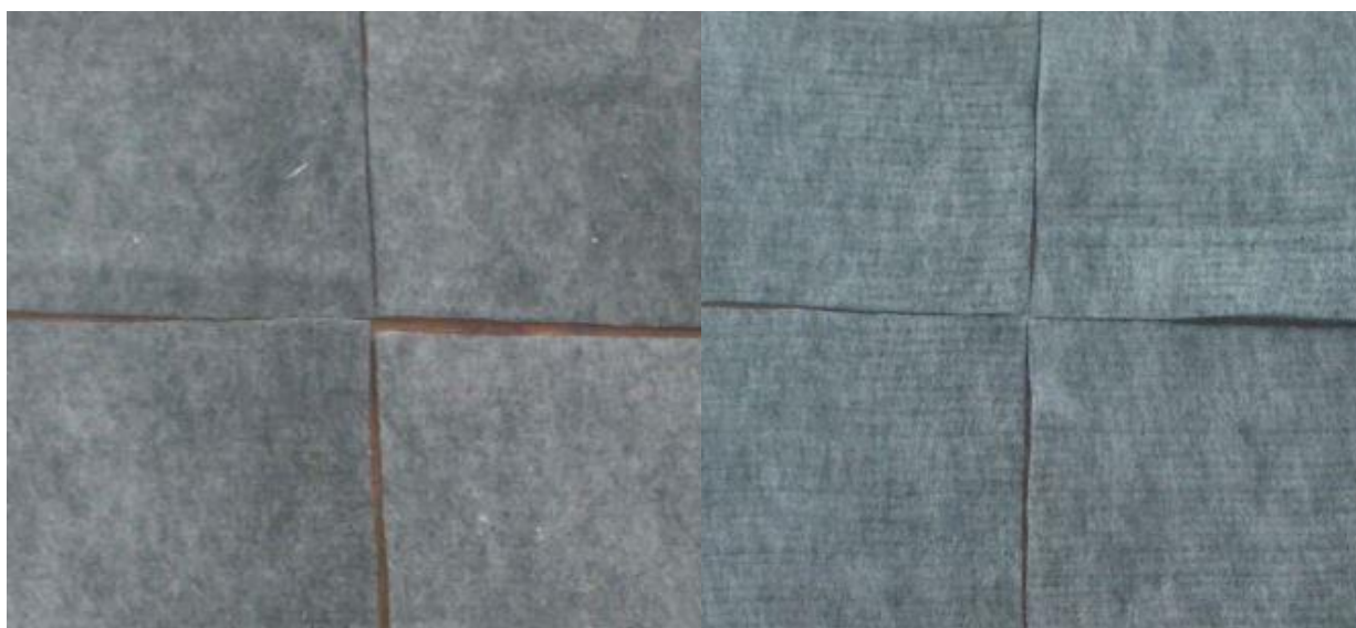
Obr. 18: netkaná textilie bez mřížky, s 0,1% nanovláken, vlevo (líc) a vpravo (rub)
