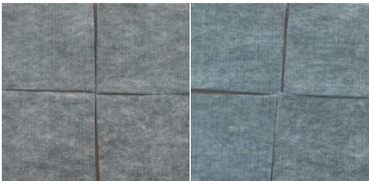
Obr. 17: netkaná textilie s mřížkou, s 0,1% nanovláken, vlevo (líc) a vpravo (rub)
