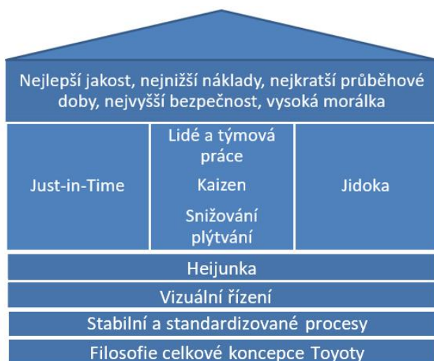
Obrázek 1: Schéma TPS jako příklad systému Štíhlé výroby
