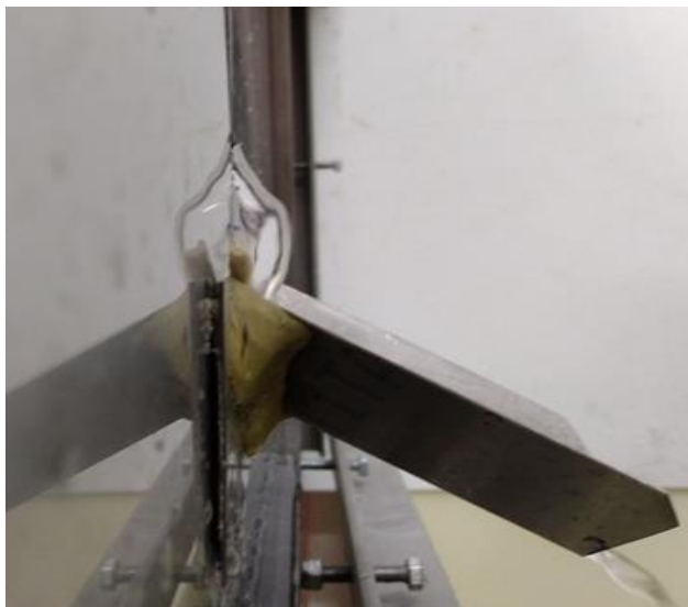
Obrázok 13 Tvar prúdu prepádajúcej vody pri uhle výrezu 10,19^\circ (pohľad z boku)
