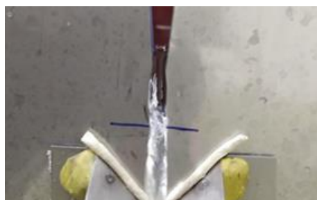
Obrázok 24 Hladina vody pri uhle výrezu 10,19^\circ (voda sa prelieva)
