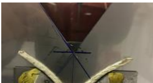
Obrázok 19 Hladina vody pri uhle výrezu 60,69^\circ (voda sa neprelieva, vplyvom povrchového napätia)
