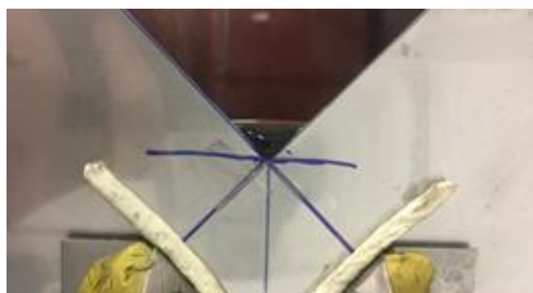
Obrázok 17 Hladina vody pri uhle výrezu 90^\circ (voda sa neprelieva, vplyvom povrchového napätia)
