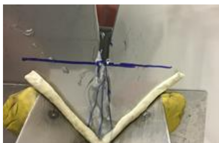
Obrázok 22 Hladina vody pri uhle výrezu 20,23^\circ (voda sa prelieva)
