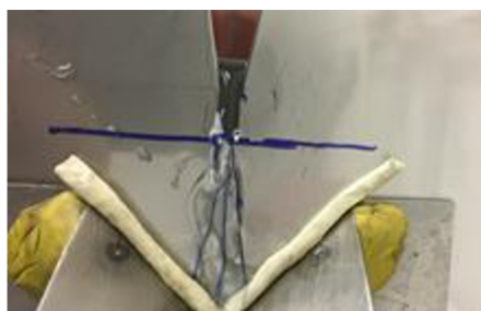
Obrázok 22 Hladina vody pri uhle výrezu 20,23^\circ (voda sa prelieva)
