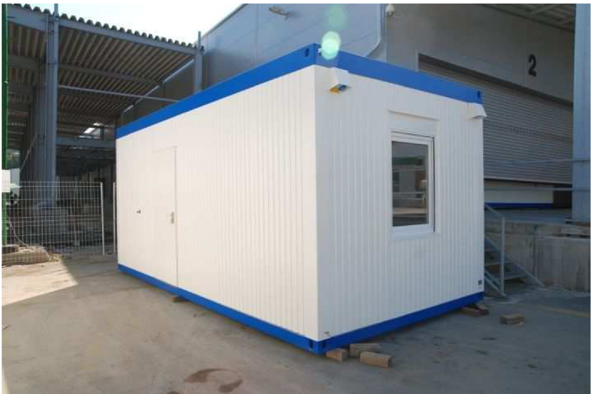
Obr. č. 7.7. Stavební buňka
