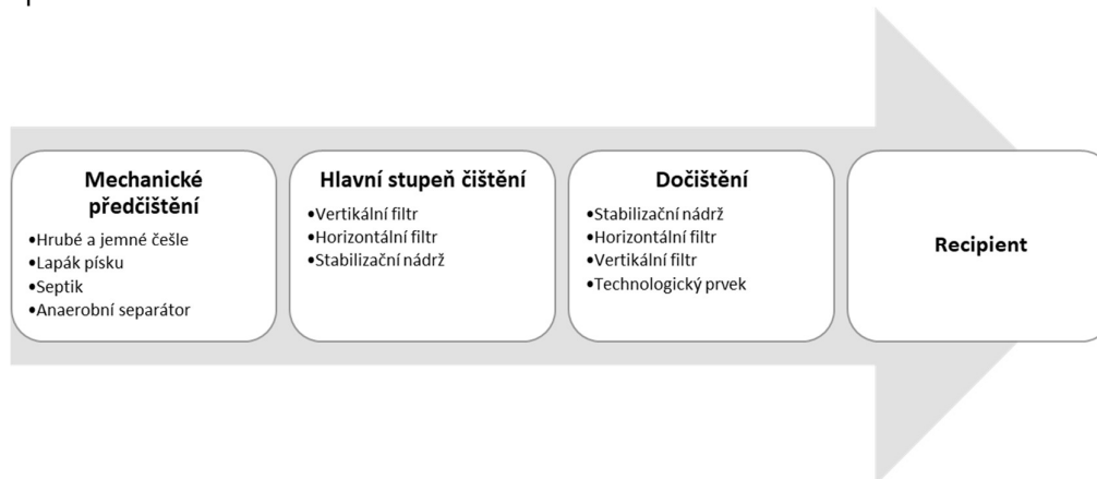
Obr. č. 11: Schematické konstrukční uspořádání přírodních čistíren
