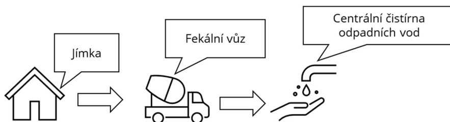
Obr. č. 8: Schéma jímky na vyvážení
