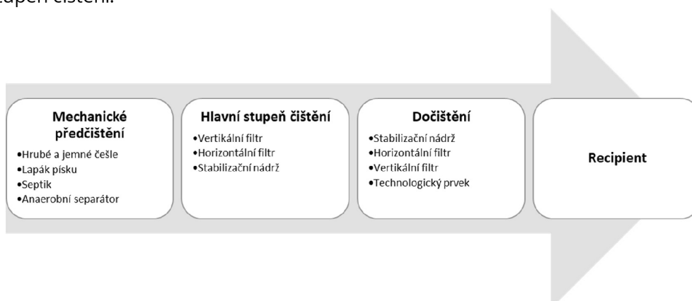
Obr. č. 11: Schematické konstrukční uspořádání přírodních čistíren
