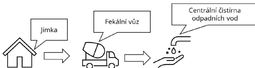
Obr. č. 8: Schéma jímky na vyvážení
