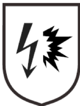
Obrázek 5.7 Ochrana před tepelným účinkem elektrického oblouku (převzato z [13])
