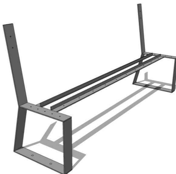
Obrázek 4: Ocelová konstrukce typu 7
