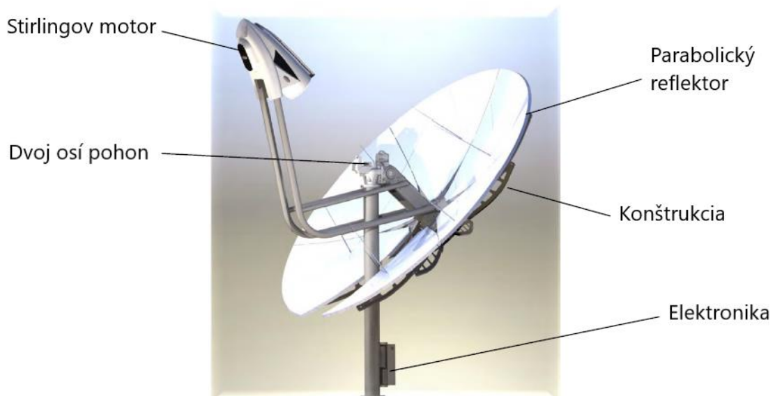
Obr. 1-6 Časti koncentrátoru s bodovým sústredením žiarenia [26]
