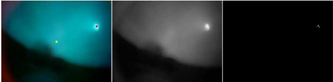
Obr. 3-10 Spracovávaný obraz; vľavo je prítomná iba clona proti intenzívnemu žiareniu s vyznačeným stredom obrazovky a jasného objektu; v strede je obraz po aplikovaní Gausianskeho filteru; vpravo je binárny obraz a z bielej časti je počítaný priemerný stred
