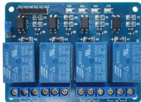
Obr. 2-15 Modul HW-316 so štyrmi relé a optočlenmi vrátane rozhrania pre mikrokontrolér za 3,74€ [27]
