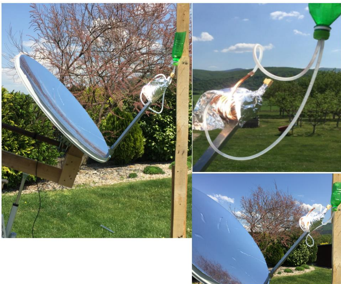
Obr. 3-13 Konfigurácia merania vyparovania vody
