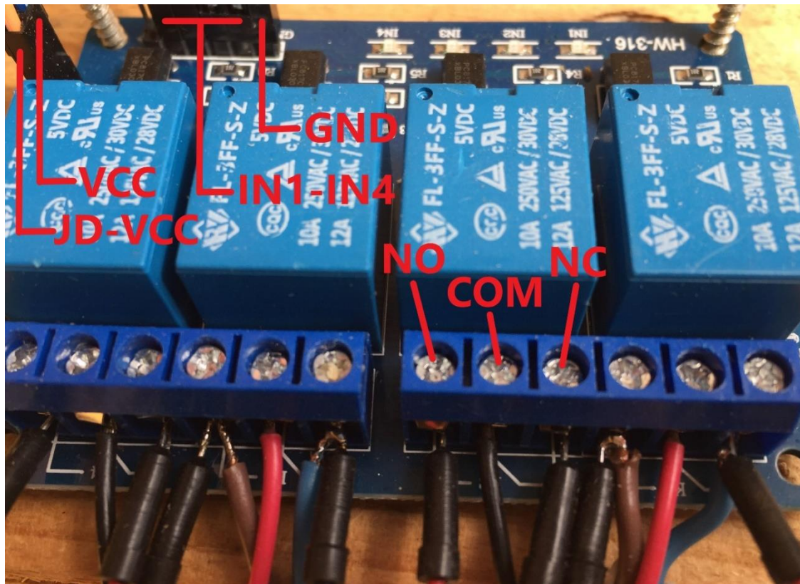
Obr. 3-5 Zapojený relé modul
