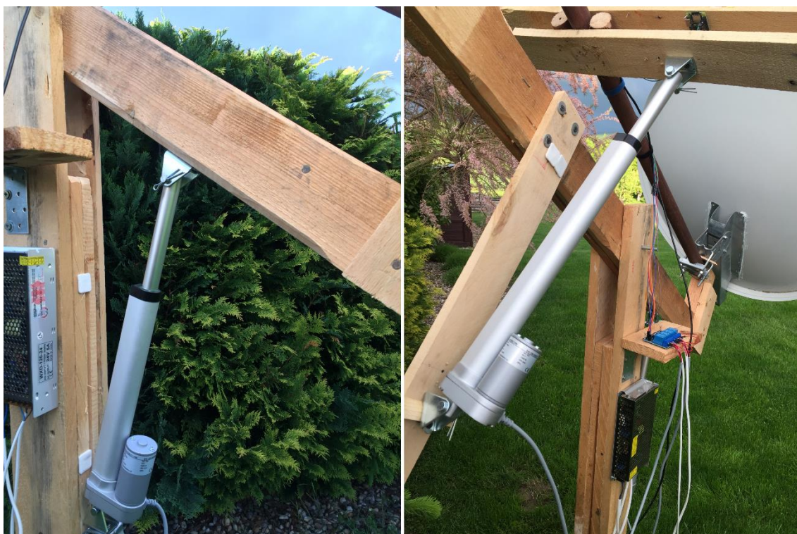
Obr. 3-3 Vľavo motor zabezpečujúci vertikálny pohyb, motor vpravo horizontálny
