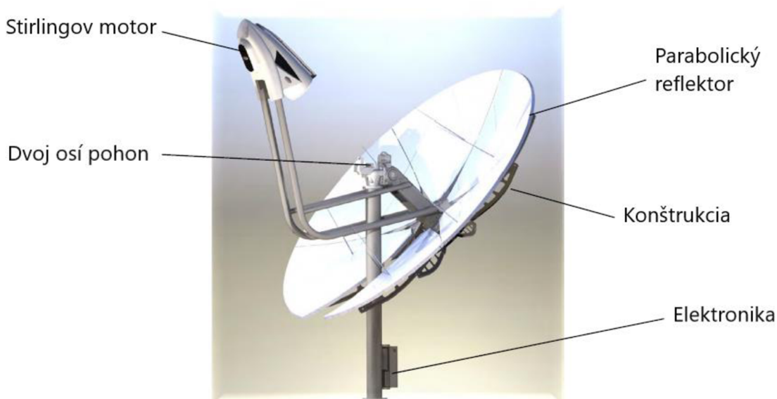
Obr. 1-6 Časti koncentrátoru s bodovým sústredením žiarenia [26]
