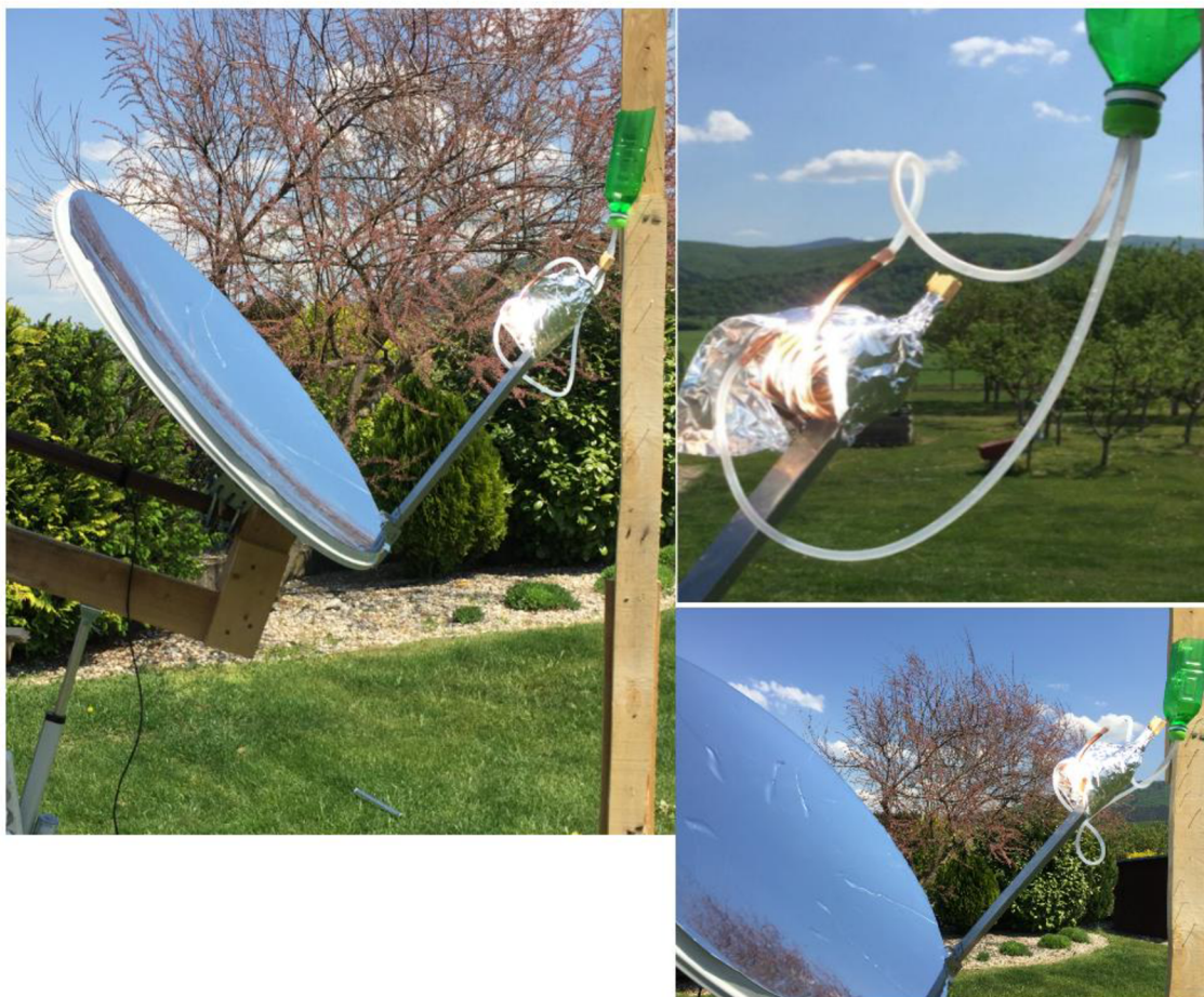
Obr. 3-13 Konfigurácia merania vyparovania vody
