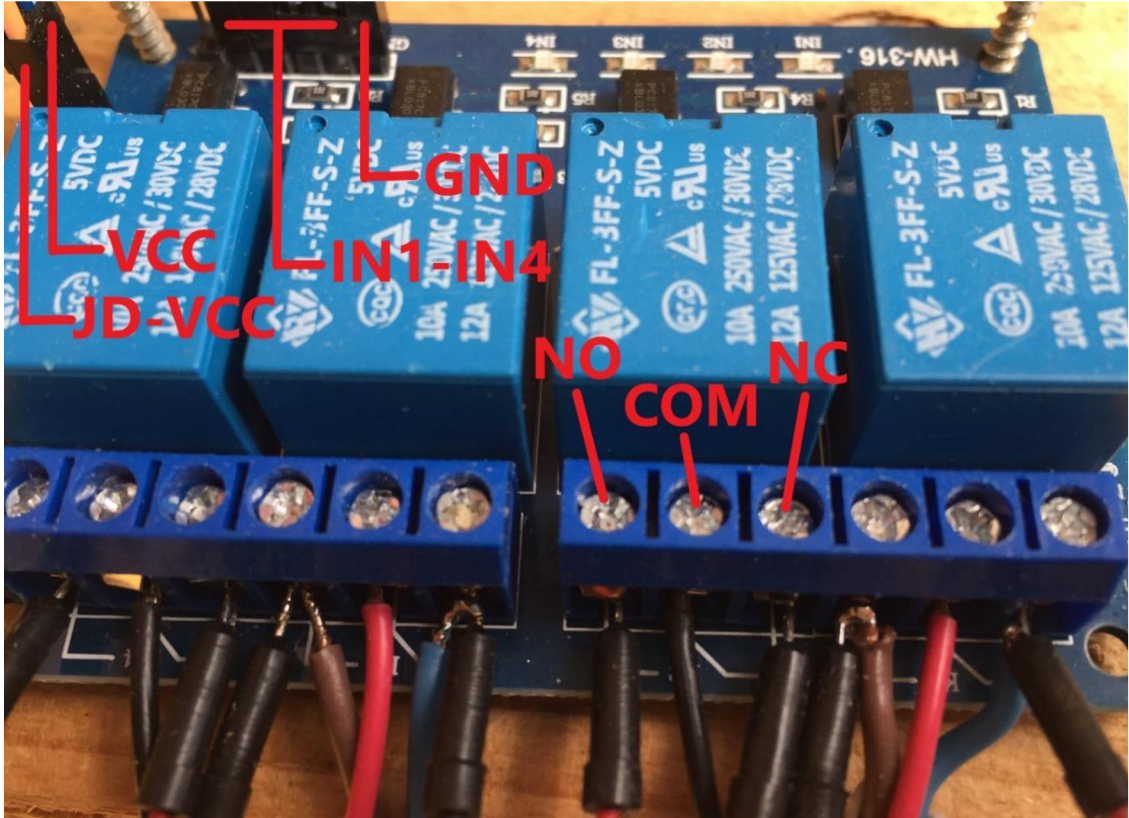
Obr. 3-5 Zapojený relé modul
