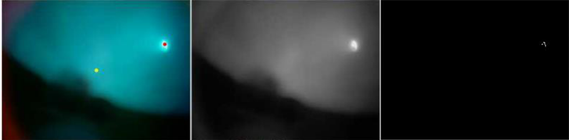
Obr. 3-10 Spracovávaný obraz; vľavo je prítomná iba clona proti intenzívnemu žiareniu s vyznačeným stredom obrazovky a jasného objektu; v strede je obraz po aplikovaní Gausiánskeho filteru; vpravo je binárny obraz a z bielej časti je počítaný priemerný stred
