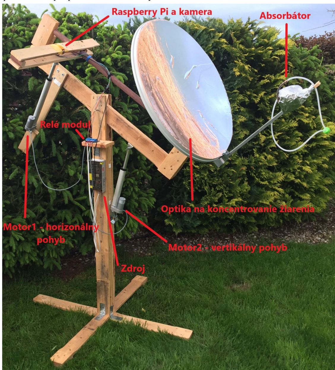
Obr. 3-1 Solárny koncentrátorový systém s automatickým polohovaním
