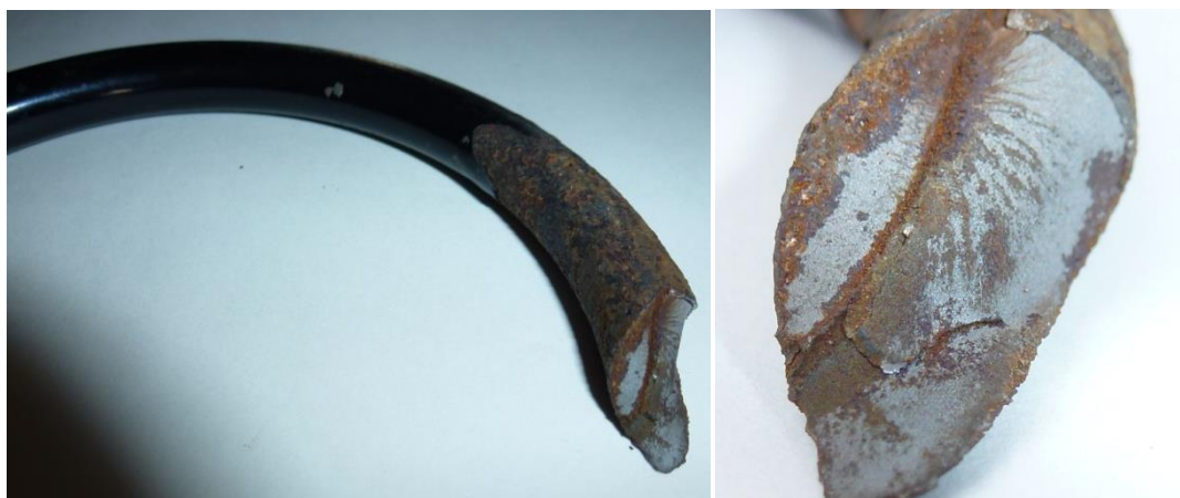
Obr. 32 Únavový lom spirálové pružiny tlumící nárazy kola osobního automobilu průměr drátu 12 mm. Vlevo – koroze na části, kde odpadla plastová ochrana. Vpravo - únavový lom v místě povrchové koroze.
