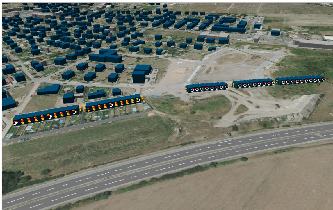
Obr. 18: Pohled na stávající (vlevo) a plánovanou (vpravo) zástavbu řadových domů a zemní valy v 3D zobrazení softwaru CadnaA – pohled na východ
