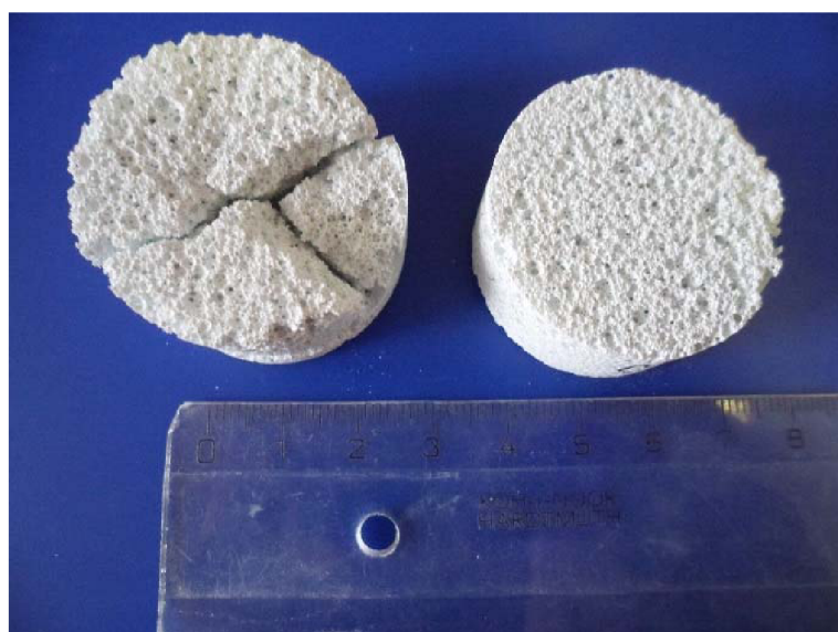
Obr. 5.13 Vlevo vzorek h=20 mm, vpravo vzorek h=17mm bez prasklin
