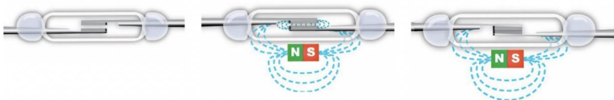
Obr. 17 Funkce jazýčkového snímače [17]
