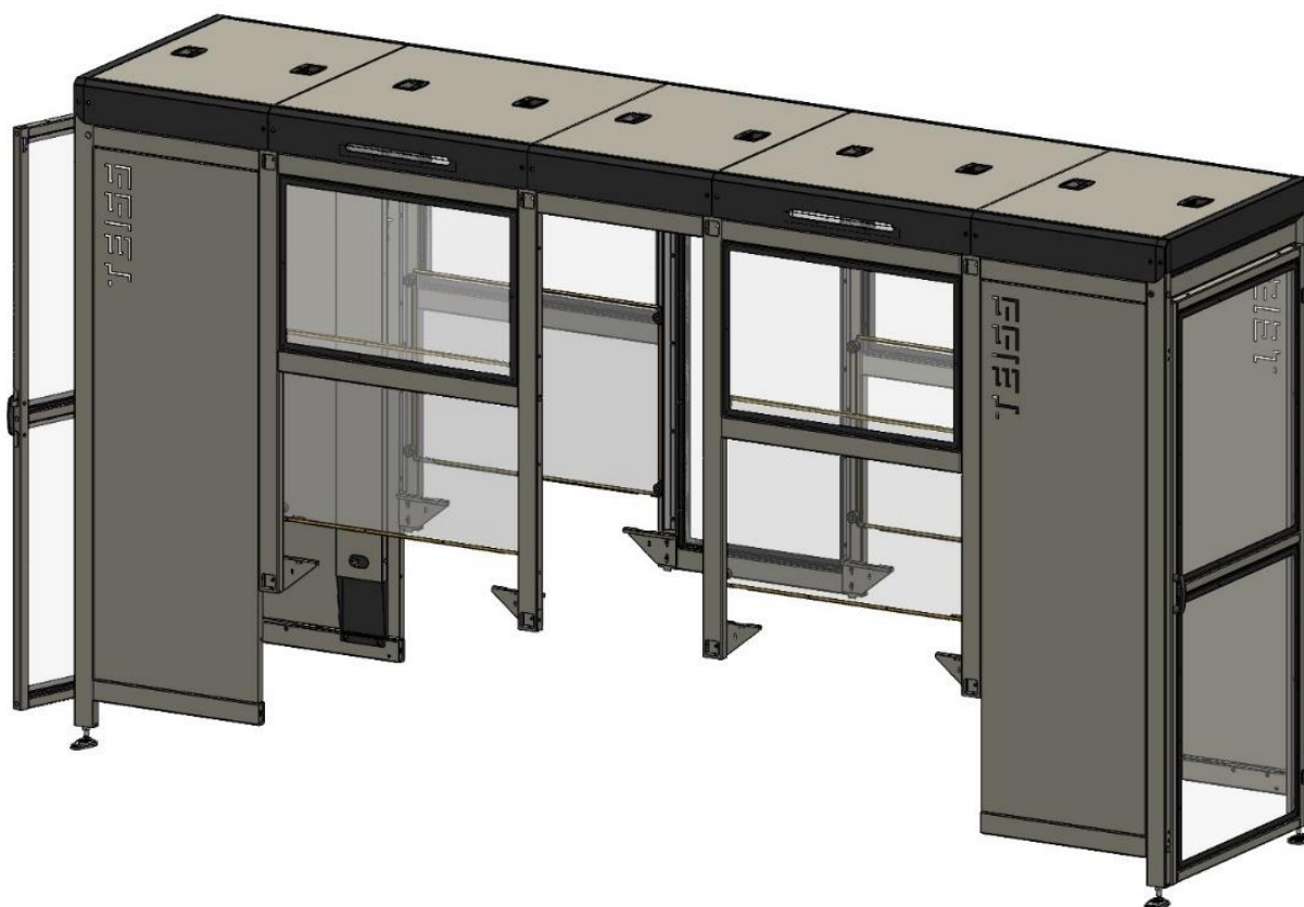
Obr. 69 Model odděleného krytování komor stroje
