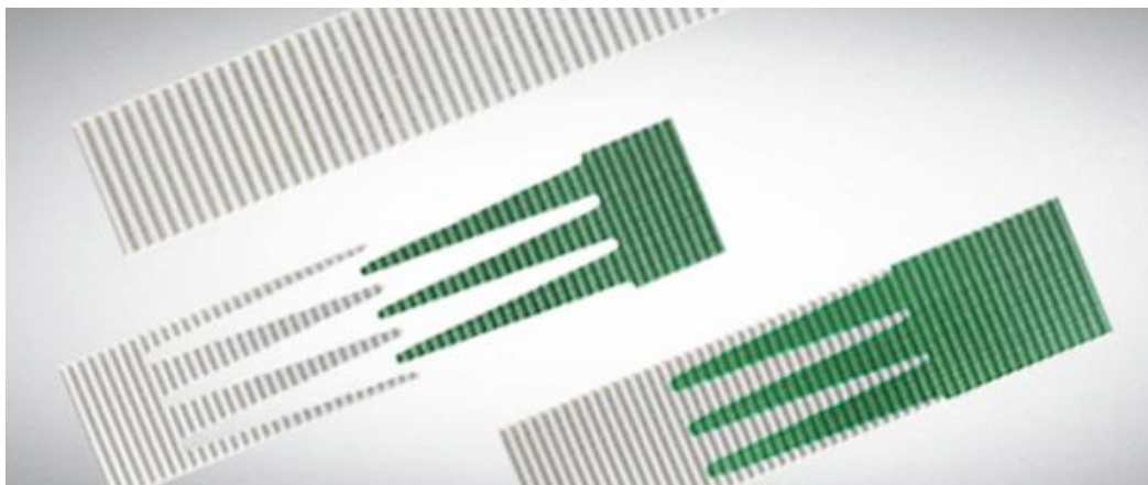
Obr. 13 Profil svařovaných konců řemene [13]
