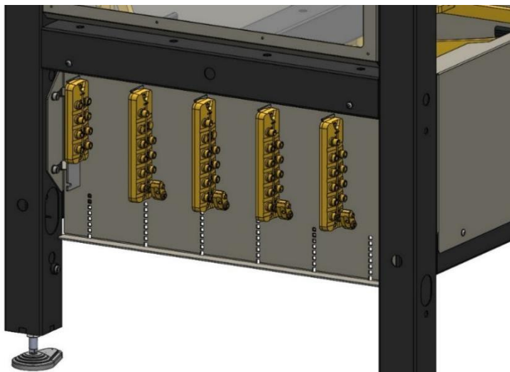
Obr. 79 Uložení IO-link modulů ve stroji
