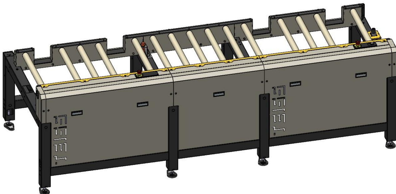
Obr. 28 Celá část válečkového dopravníku
