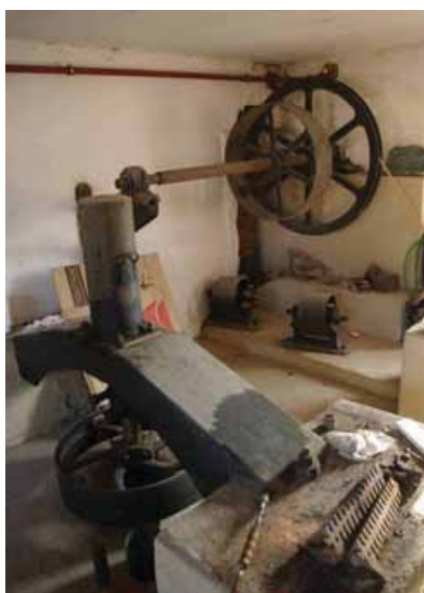
obr. 22/16 – Francisova turbína s převody (foto Matějčíček 2011).
