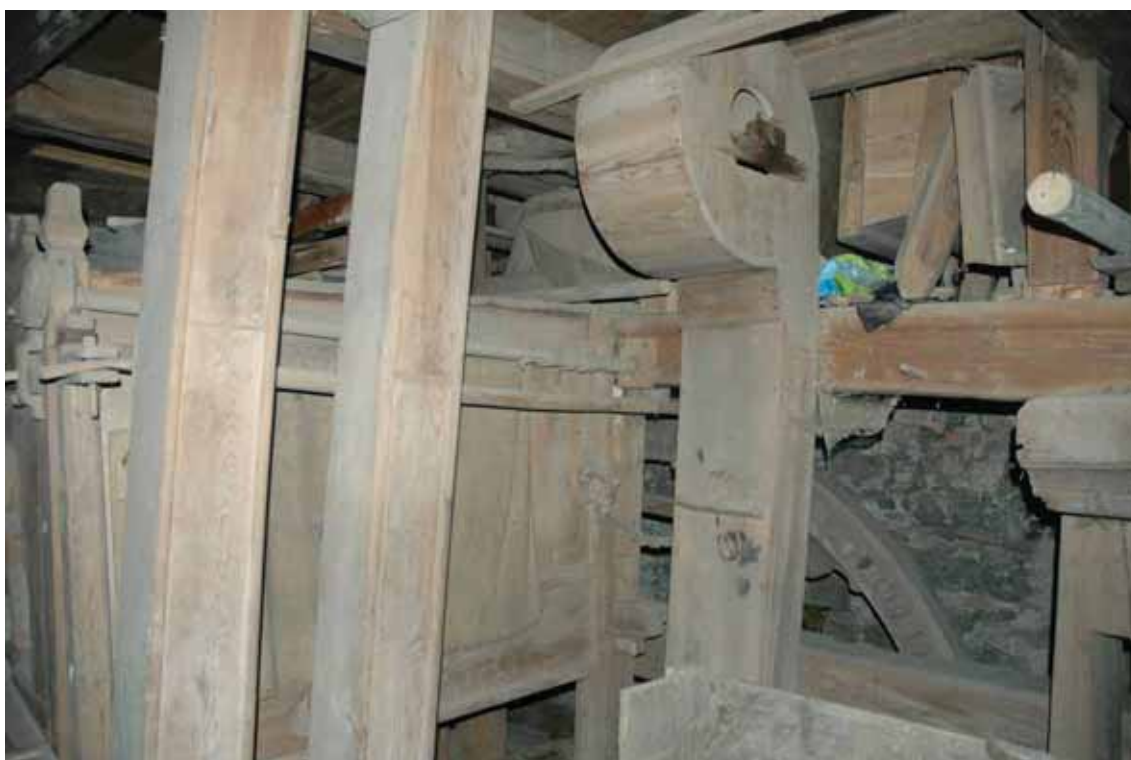
obr. 24 – Moučnice, výtah a vpravo fukar polouměleckého složení v Brodu u Bratříkovic (foto Kuča 2005).
