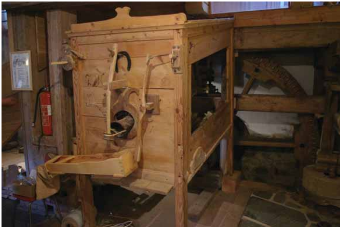
obr. 13/11 – Moučnice, v pozadí palečné kolo (foto Matějíček 2011).
