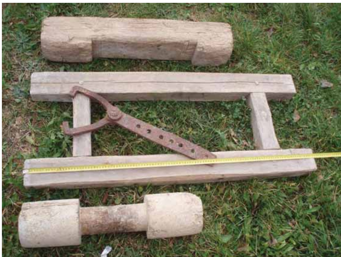
obr. 25/17 – Převracecí náčiní pro otáčení běhounu (foto Šimek 2007).
