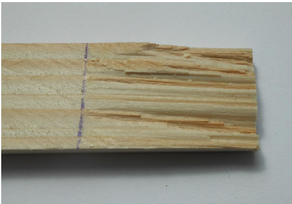
Obr. 26: Porušení lepeného spoje ve dřevě (Laštovička)
