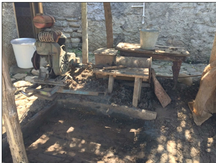
Obrázek 2 Zpracování hlíny na výrobu kvevri (foto autor)
