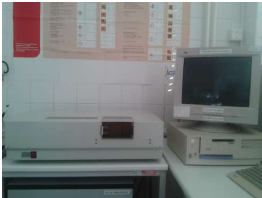
Obrázek 5: Atomový absorpční spektrometr pro analýzu rtuti AMA 254 (Altec, Česká republika)
