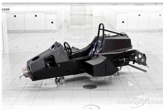
Obrázek 1.32: Monokok monopostu McLaren MP4/1 (Piola, 2021)
