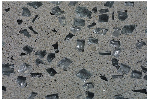
Obrázek 1.19: Polymerbeton se skleněnou drtí (MaterialDistrict, 2005)
