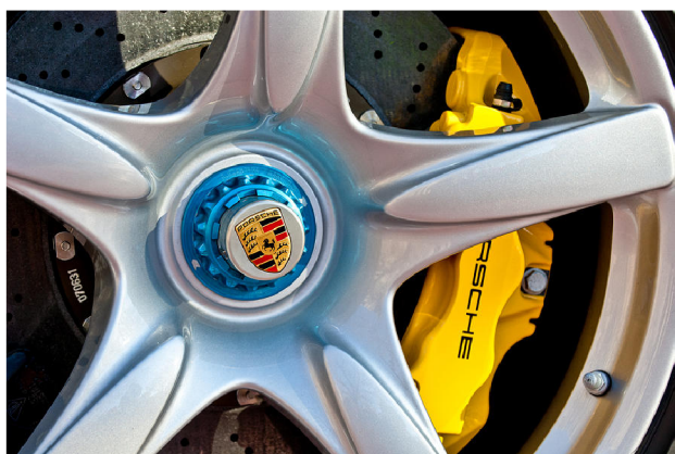
Obrázek 1.35: Detail na ráfek z hořčíkové slitiny na voze Porsche Carrera GT (Delgado, 2019)
