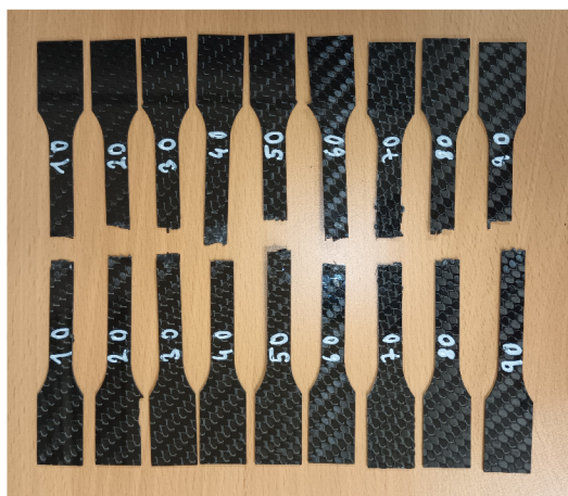
Obrázek 4.6: Přelámané vzorky ohybem
