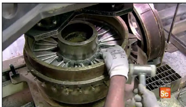
Obrázek 1.26: Forma s vloženými jádry (MechanicalEngineering, 2023)
