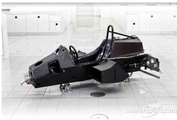
Obrázek 1.32: Monokok monopostu McLaren MP4/1 (Piola, 2021)
