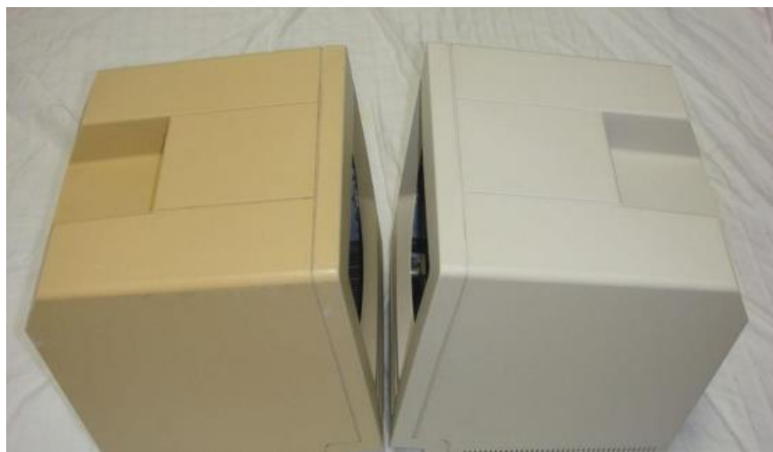
Obr. 2.13 Typický projev stárnutí polymerů – zežloutnutí [31]
