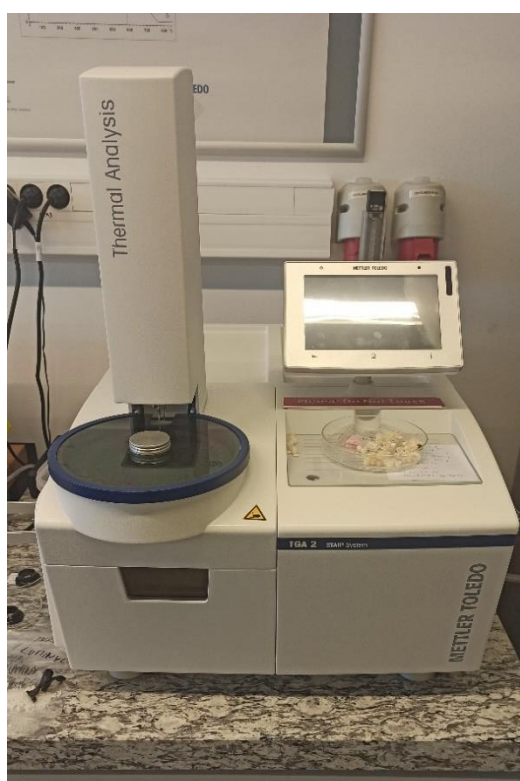
Obr. 3.21 Termogravimetrický analyzátor TGA 2 od firmy Mettler Toledo
