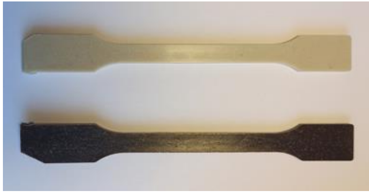
Obr. 3.8 Vstřikovaná zkušební tělesa (nahore PLA + 20 hm% ES, dole PLA + 20 hm% BH)
