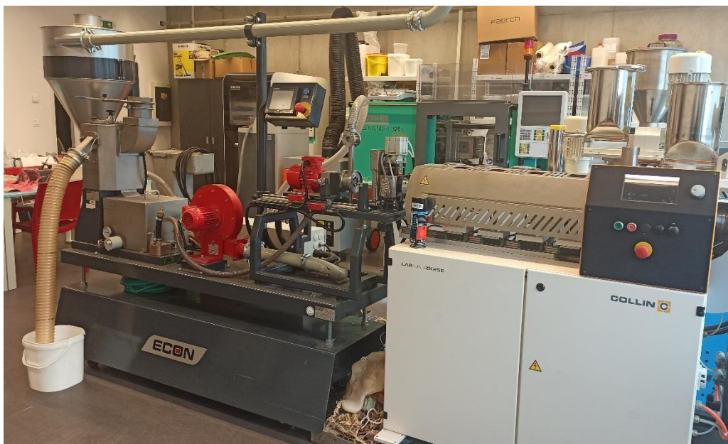
Obr. 3.6 Dvoušnekový extrudér Lab-Line ZK 25 s granulační jednotkou ECON EWA 10
