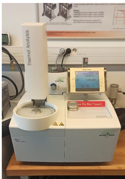
Obr. 3.18 Diferenční snímací kalorimetr DSC1/700 od firmy Mettler Toledo
