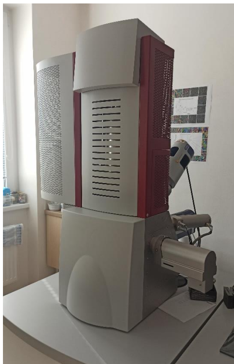
Obr. 3.24 Skenovací elektronový mikroskop TESCAN MIRA3
