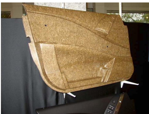
Obr. 2.12 Ukázka využití polymerních kompozitů na bázi přírodních vláken [29]
