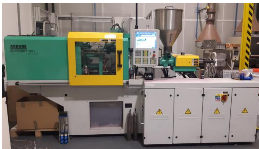
Obr. 3.7 Vstřikovací stroj Allrounder 270 S 400-100 od firmy Arburg [18]
