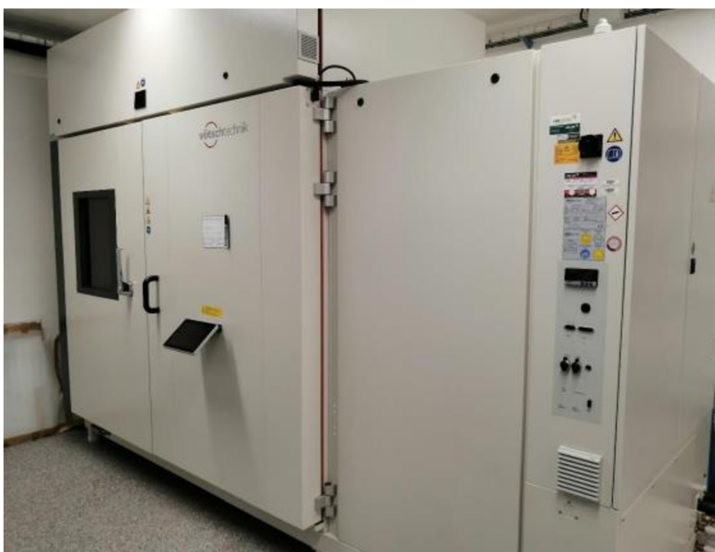
Obr. 3.10 Solární klimatická komora SUN 3600 od firmy VÖTSCH s MH zářiči (2 x 4 kW) [14]
