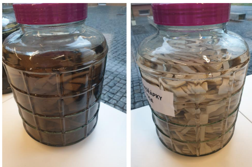
Obr. 3.9 Zkušební vzorky umístěné v nádobách se sladkou vodou (vlevo: PLA/BH, vpravo: PLA/ES)
