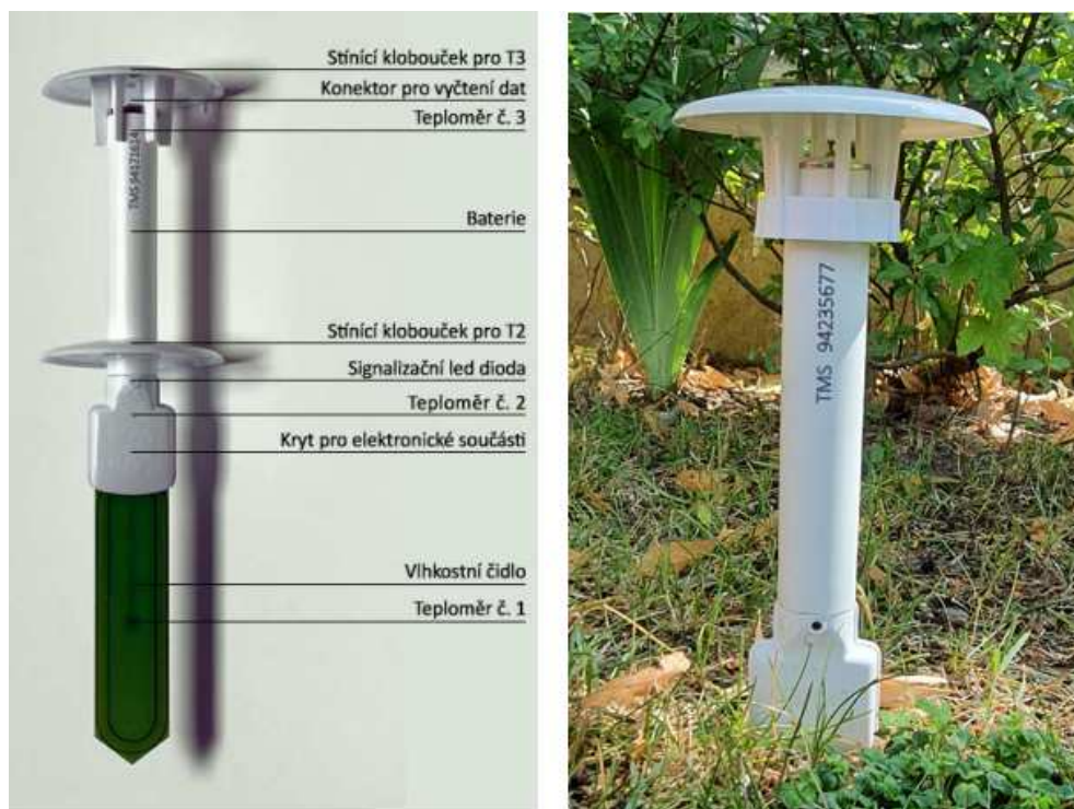
Příloha 3 – Měřicí čidlo TMS–4 (popis jeho částí, čidlo v zemi).
