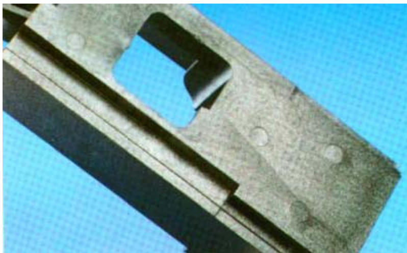
Obr. 1.7 Studený spoj u polymeru vyztuženého skleněnými vlákny [7]
