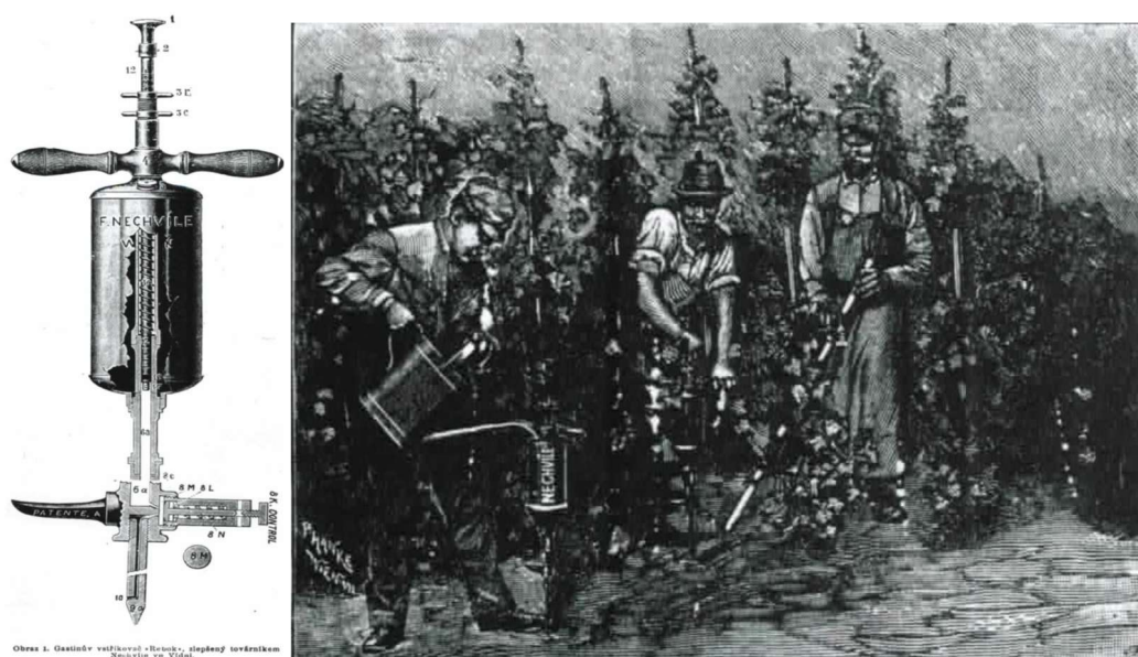
Obr. 6: Vstříkovač sirouhlíku a jeho aplikace ve vinici (FOŘT, 1902)
