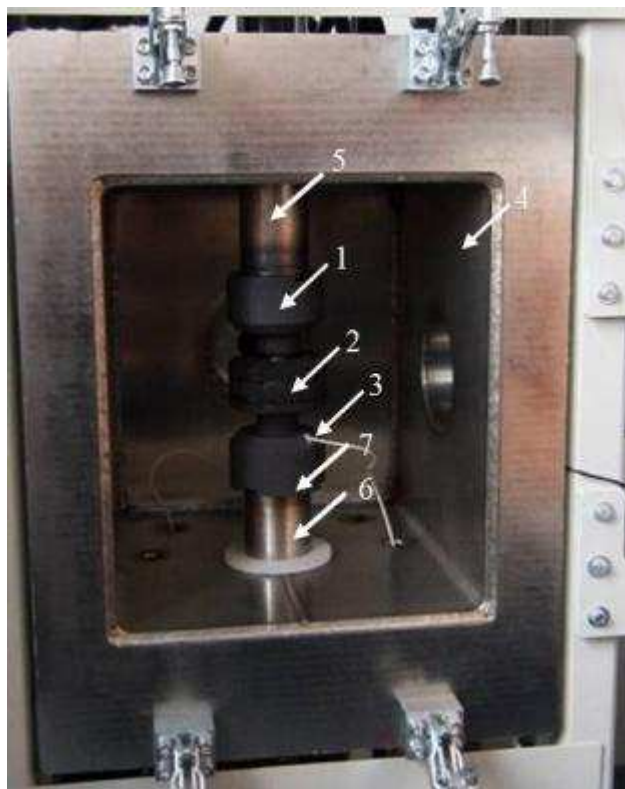
Obr. 5-8 komora přístroje SPS 10-4 s vloženou grafitovou lisovnicí [107], 1 – horní grafitový píst; 2 – lisovnice se vzorkem; 3 – termočlánek; 4 – komora SPS; 5, 6 - ocelové písky lisu; 7 – spodní grafitový píst
