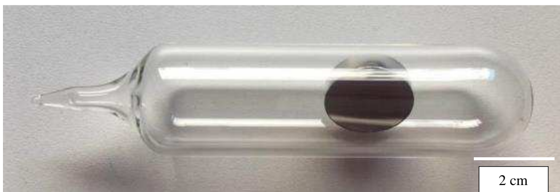
Obr. 5-3: Zatavený vzorek ve skleněné ampuli s argonovou atmosférou
