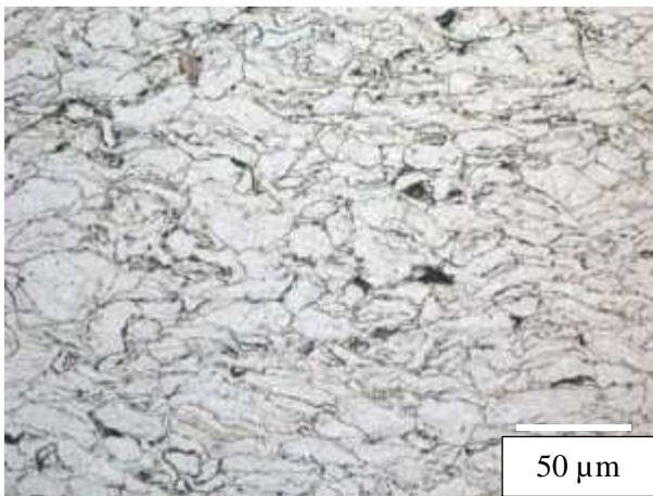
Obr. 6-20: Mikrostruktura materiálů připravených pomocí SPS, předlisovací tlak tablet 100 MPa až 500 MPa a volně sypaný prášek, teplota při SPS 500 °C, tlak při SPS 100 MPa
