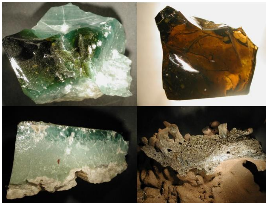
Obrázek 8 Skelné a skleněné krystalické vrstvy vzniklé při spalování slámy [9]
