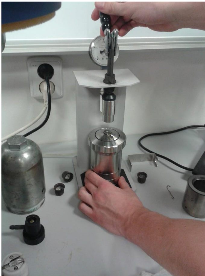
Obrázek 13 Naplňování rozkladné nádoby kyslíkem
