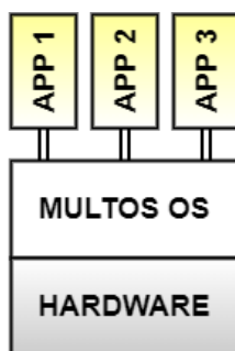
Obr. 2.4: Schéma komunikace apletů s hardware MultOS.
