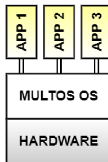
Obr. 2.4: Schéma komunikace apletů s hardware MultOS.
