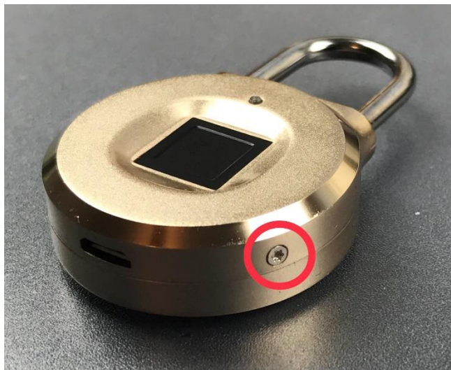
Obrázek 1 - Visací zámek se špatnou mechanickou ochranou
