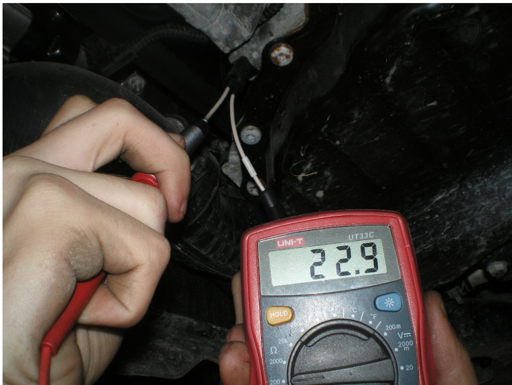
Obrázek č. 67 - Měření odporu snímače otáček
