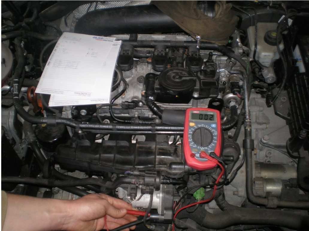
Obrázek č. 57 - Měření odporu vinutí elektromotoru nastavovače škrticí klapky
