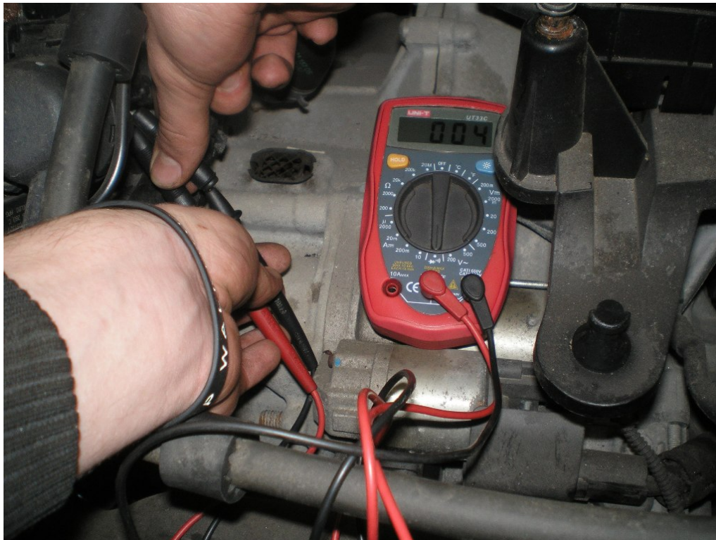
Obrázek č. 50 - Měření odporu vinutí vstřikovacího ventilu
