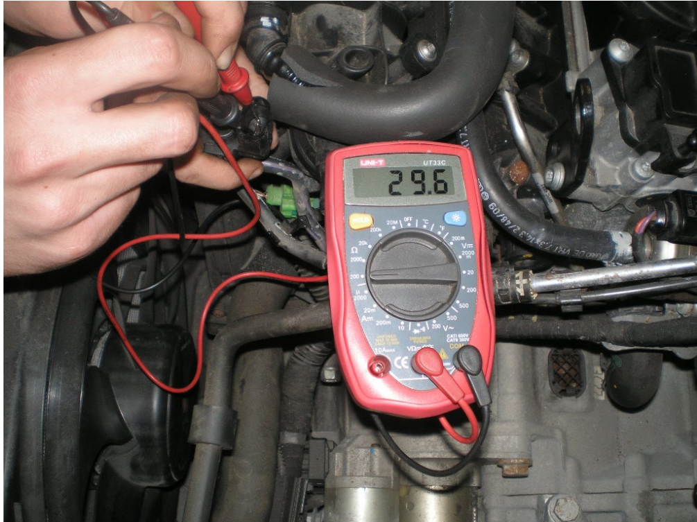
Obrázek č. 62 - Měření odporu elmg. ventilu škrticích klapek
