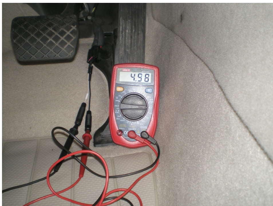
Obrázek č. 72 - Měření napájecího napětí snímače polohy pedálu akcelerace
