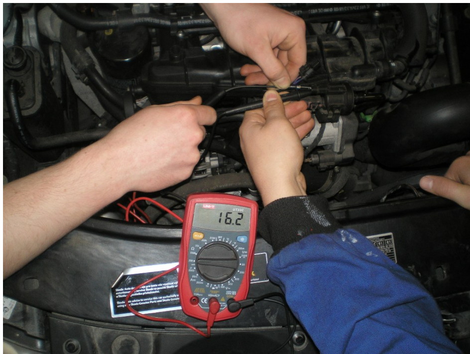
Obrázek č. 73 - Měření odporu vinutí elmg. ventilu
