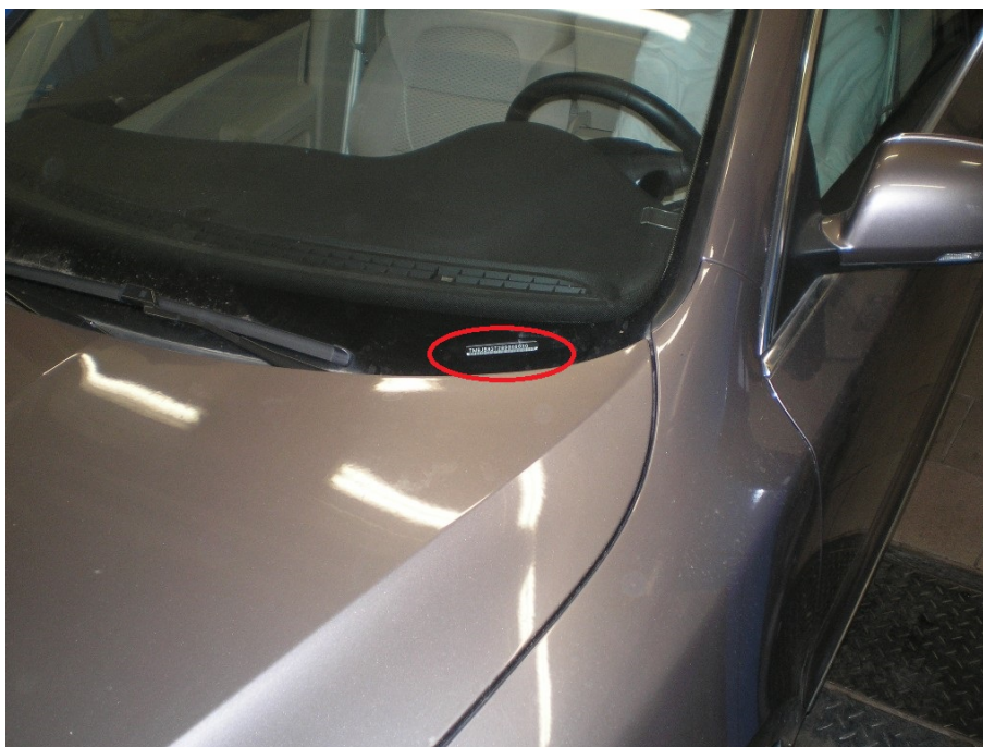
Obrázek č. 4 – Umístění pomocného VIN kódu
