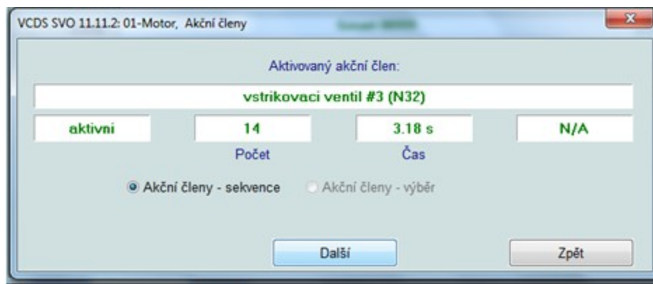
Obrázek č. 41 - Okno aktivace akčního členu - vstřikovacího ventilu
