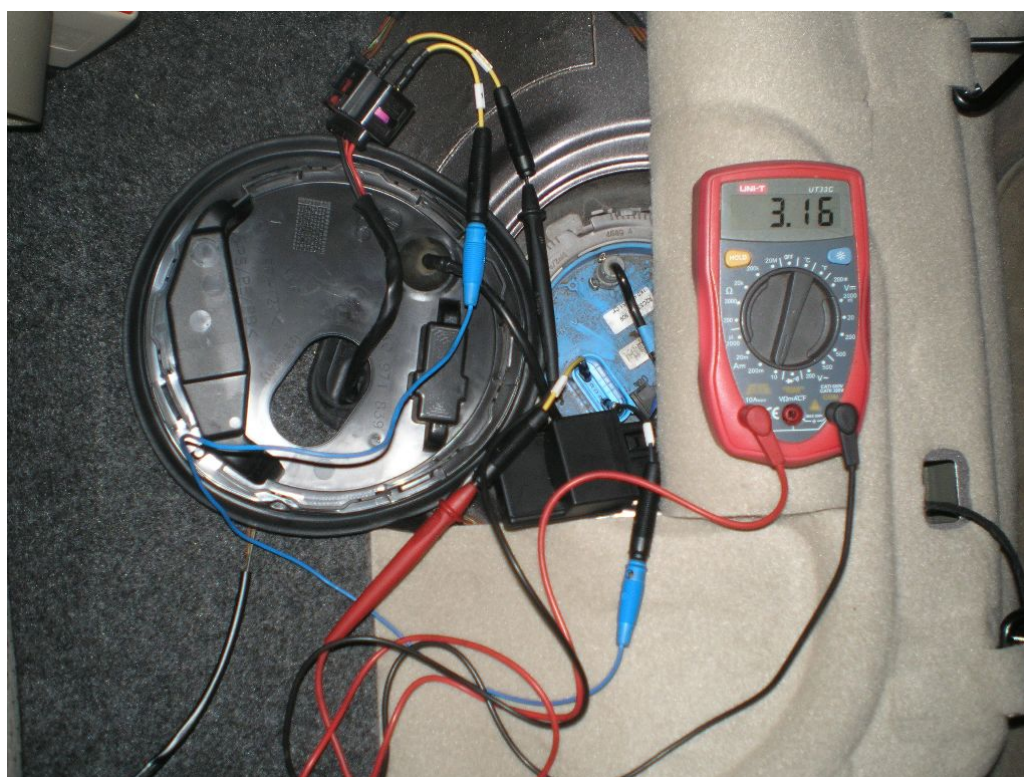
Obrázek č. 46 - Měření proudu na palivovém čerpadle
