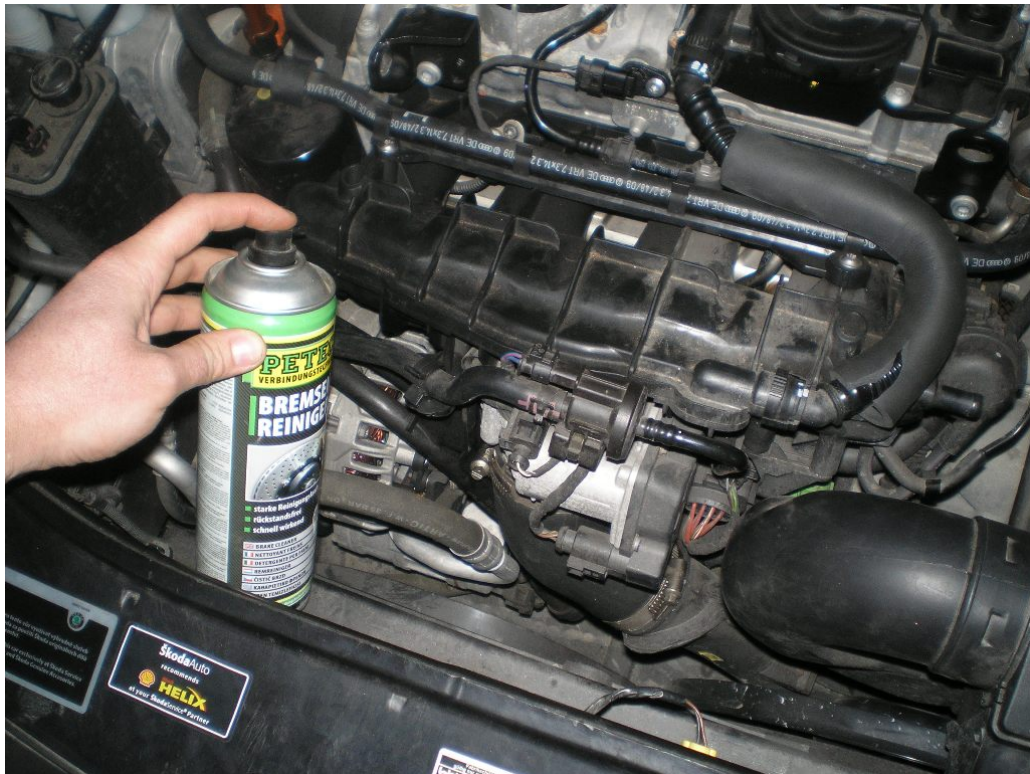
Obrázek č. 53 - Kontrola těsnosti sacího potrubí
