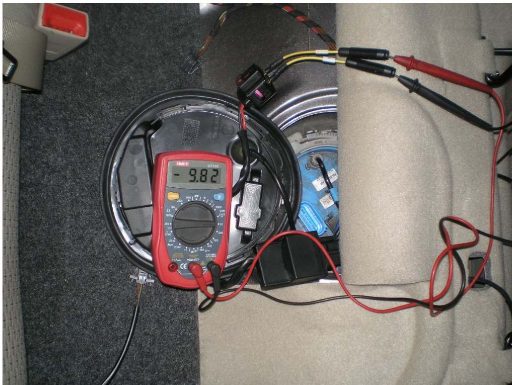
Obrázek č. 47 - Měření napětí na palivovém čerpadle
