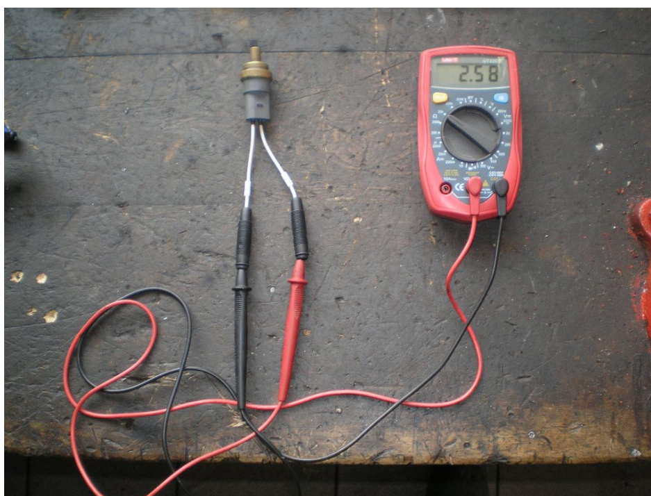
Obrázek č. 65 - Měření odporu demontovaného snímače teploty motoru
