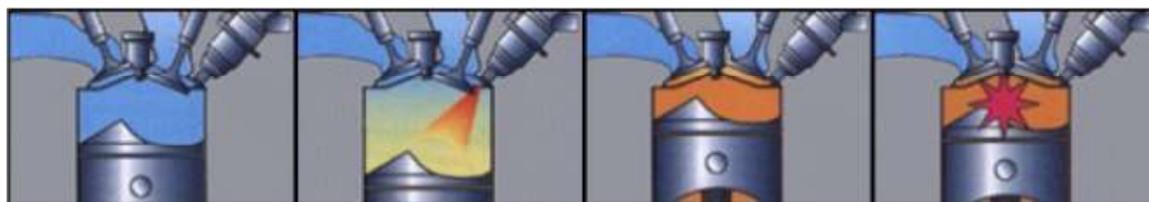
Obrázek č. 10 - Spalování homogenní směsi, zdroj: GSCHEIDLE (2001)
