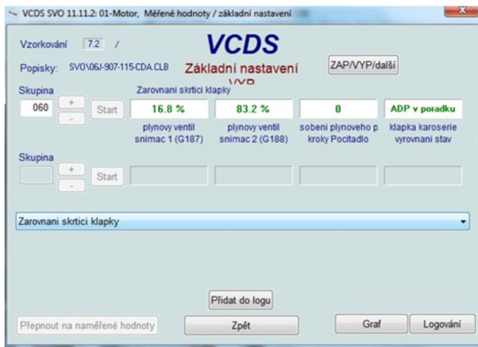
Obrázek č. 40 - Základní nastavení škrticí klapky
