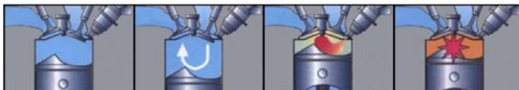
Obrázek č. 9 – Spalování vrstvené (heterogenní) směsi, zdroj: GSCHEIDLE (2001)
