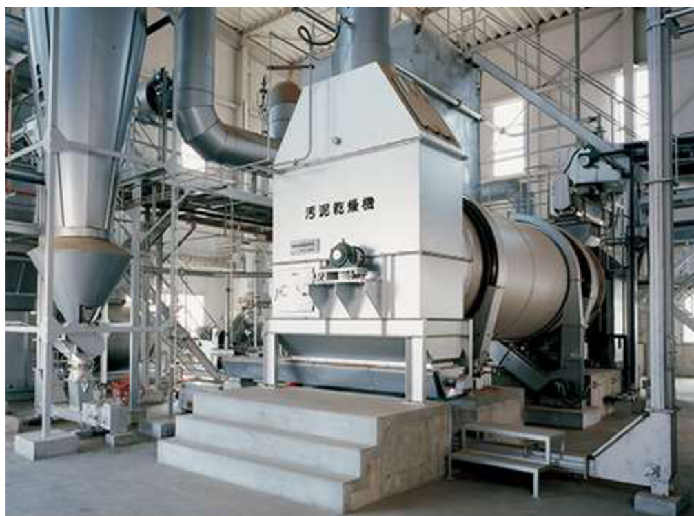
Obr. 6 Rotačná bubnová sušička kalu [47]
