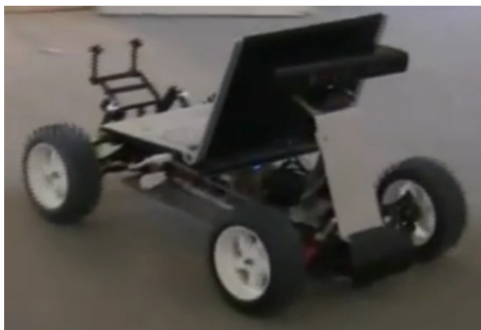
Obr. 6: Čtyřkolový robot s čidlem MS Kinect.[8]
