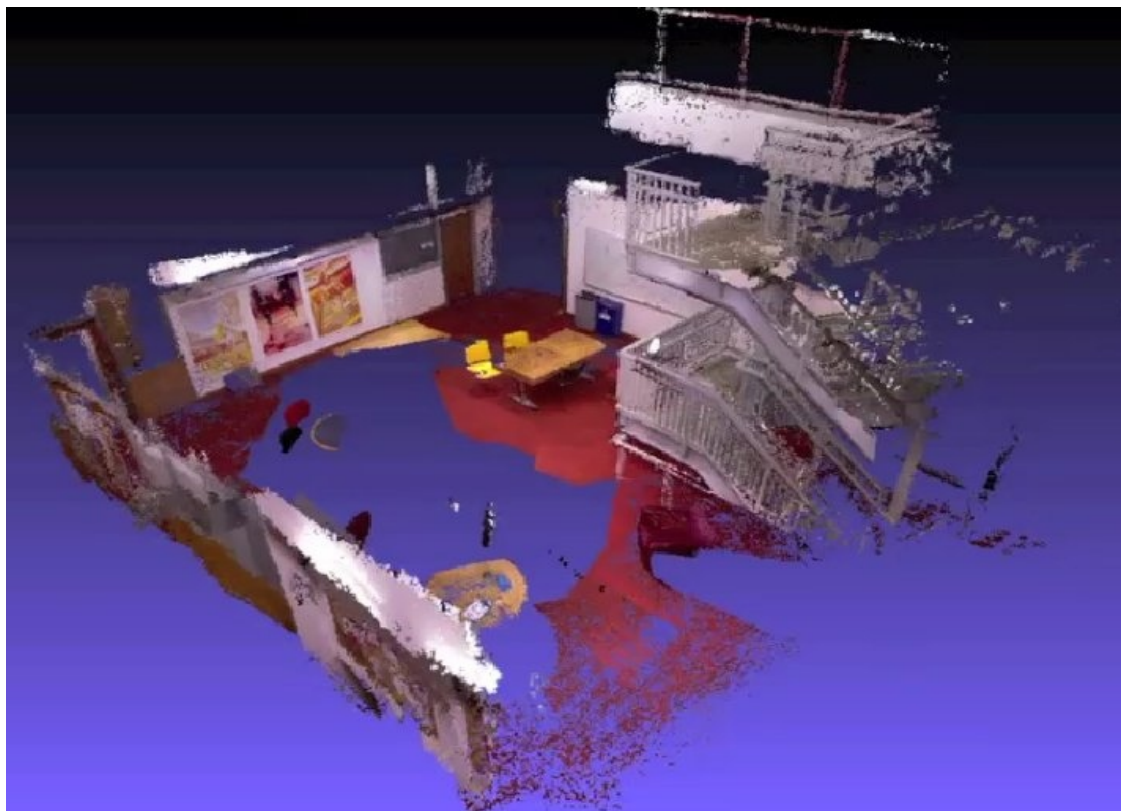
Obr. 5: 3D model vytvořený helikoptérou s čidlem MS Kinect.[7]
