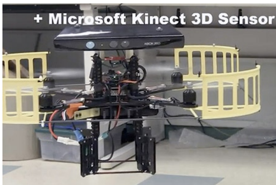
Obr. 4: Čtyřvrtulová helikoptéra s čidlem MS Kinect.[6]
