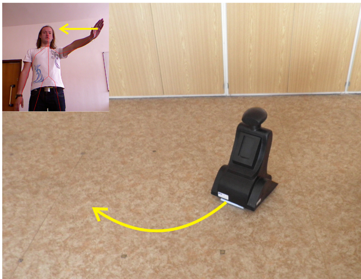
Obr. 41: Pohyb robotu v závislosti na pohybu ruky
