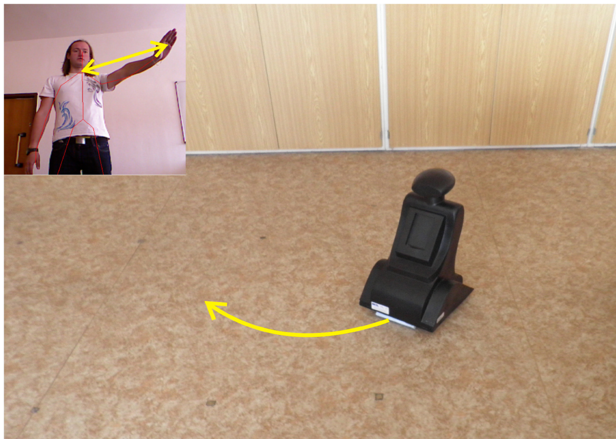
Obr. 40: Pohyb robotu v závislosti na vzdálenosti ruky od spodní části krku
