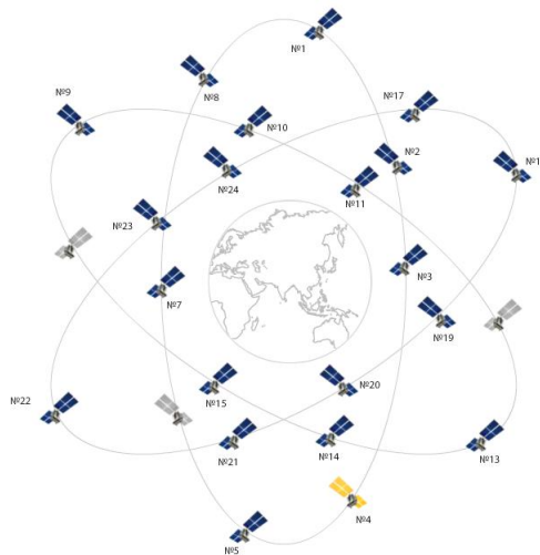
Obr. 1.2: Kosmický segment GLONASS; převzato z (ESA, 2020)
